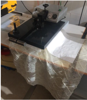
21. Proceso transferencia con plancha de calor y presión sobre algodón.
