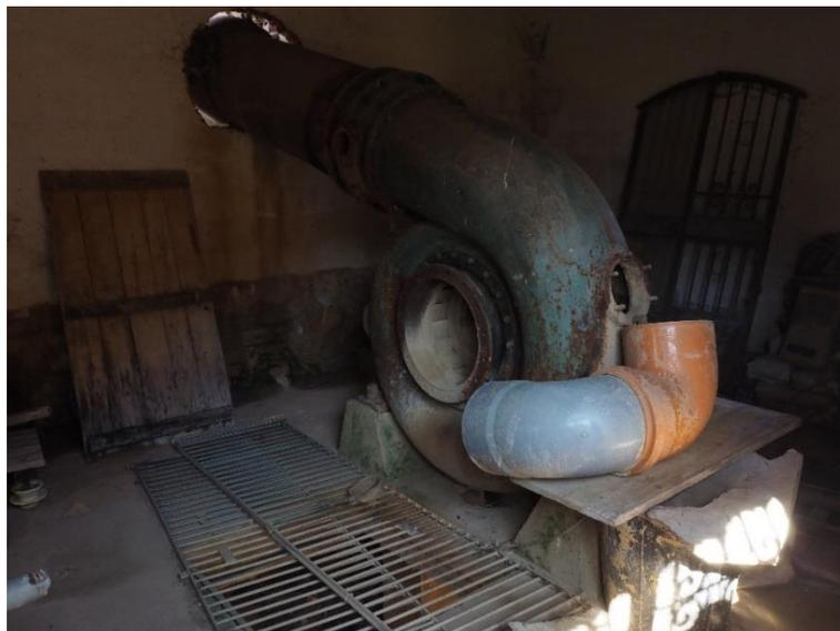
*Figura 3 – Imagen de la turbina encontrada en la casa del molino durante la visita técnica*
