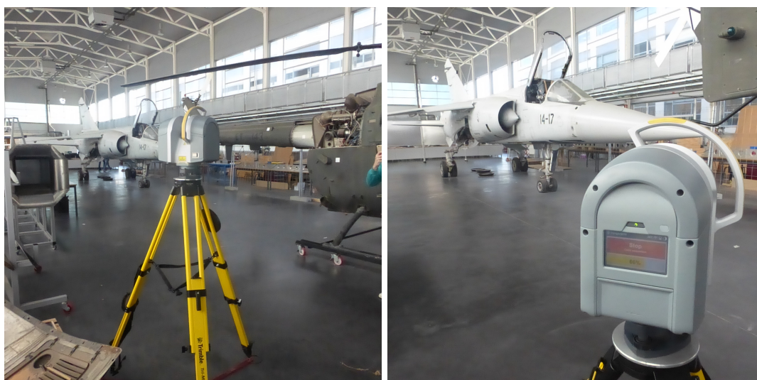
Figura 2.1: Trimble TX6 en el Edificio 7L de la UPV.
