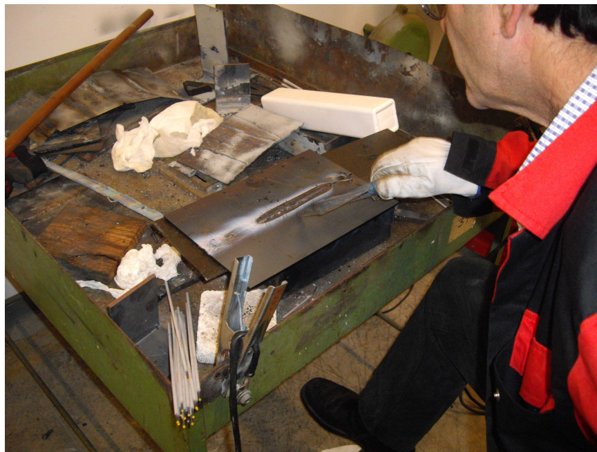
Soldadura entre dos chapas de 300x75x3 mm
