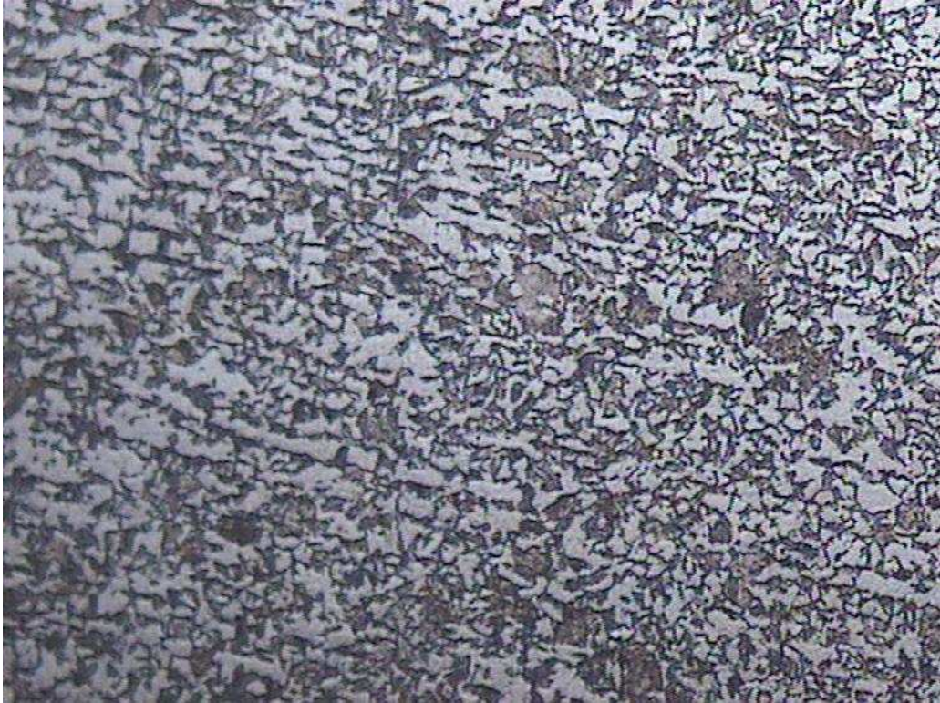
Muestras Material Base F-1140 con soldadura de electrodo de acero inox. 400 x
