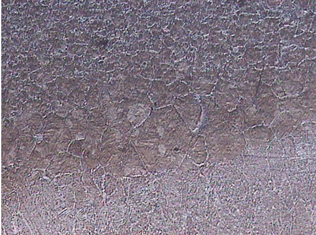
Zona afectada por el calor F-1140 con soldadura de electrodo básico 50 x
