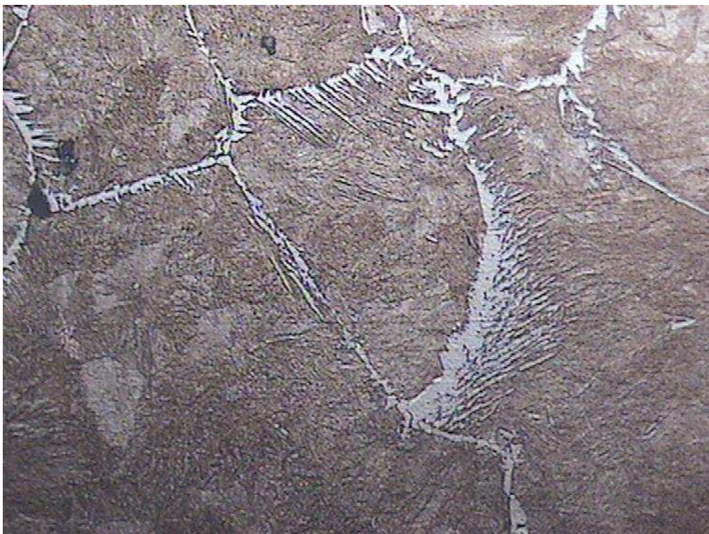
Zona afectada por el calor F-1140 con soldadura de electrodo básico 200 x
