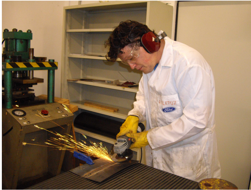
Proceso de lijado de la soldadura
