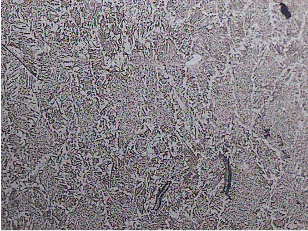
Zona del material de aporte (soldadura) F-1140 con soldadura de electrodo básico 100 x
