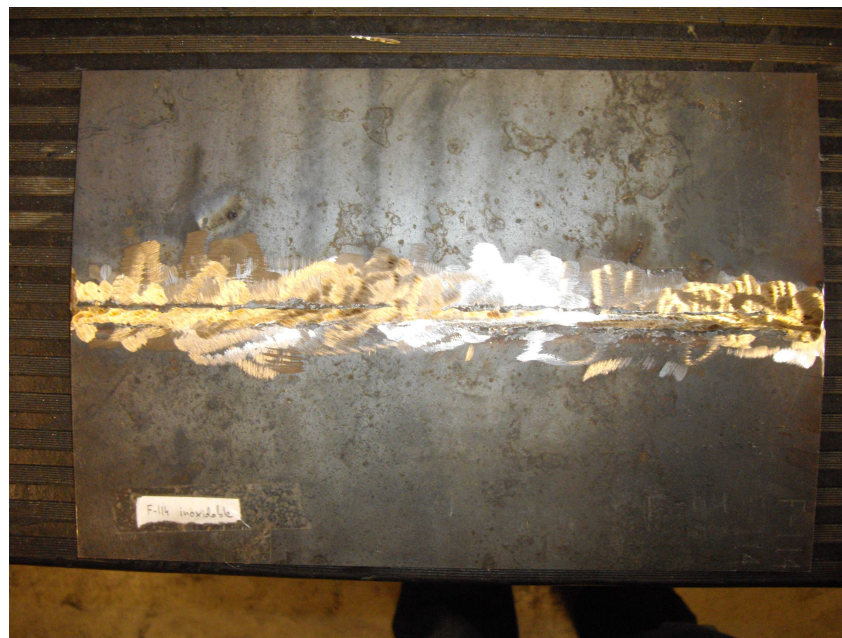
Soldadura tratada para los ensayos posteriores
