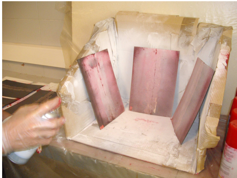
Aplicación de líquido revelador
