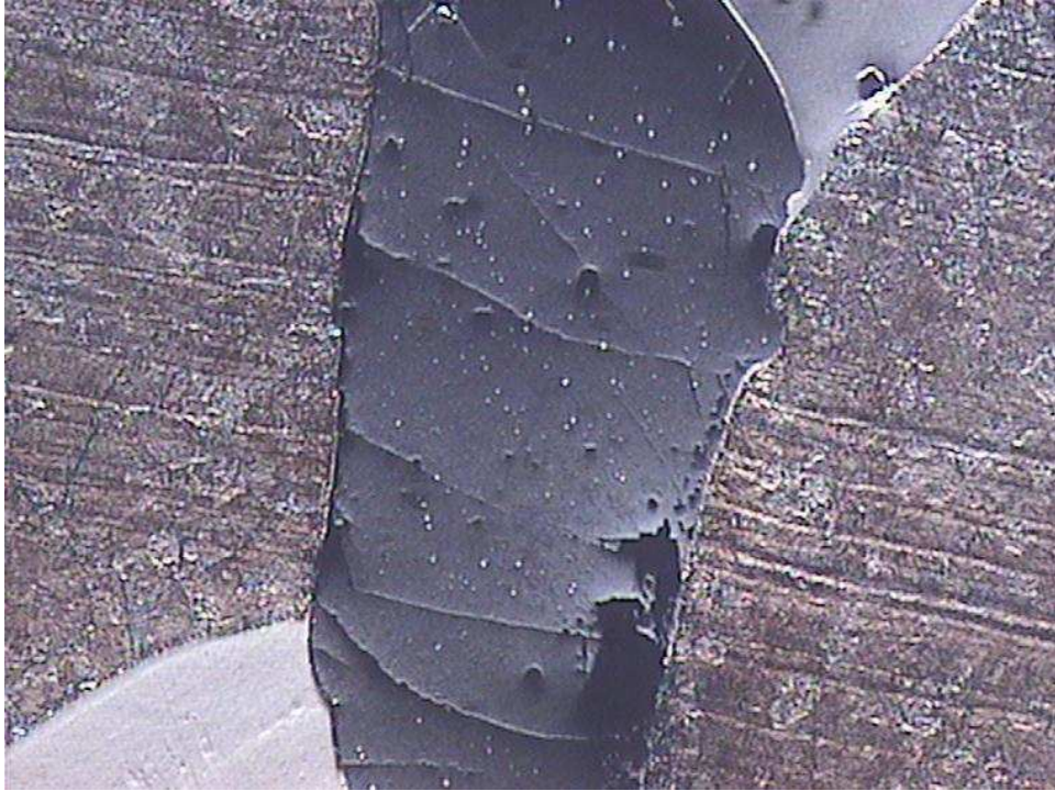
Inclusión en la soldadura de acero inoxidable a50 aumentos
