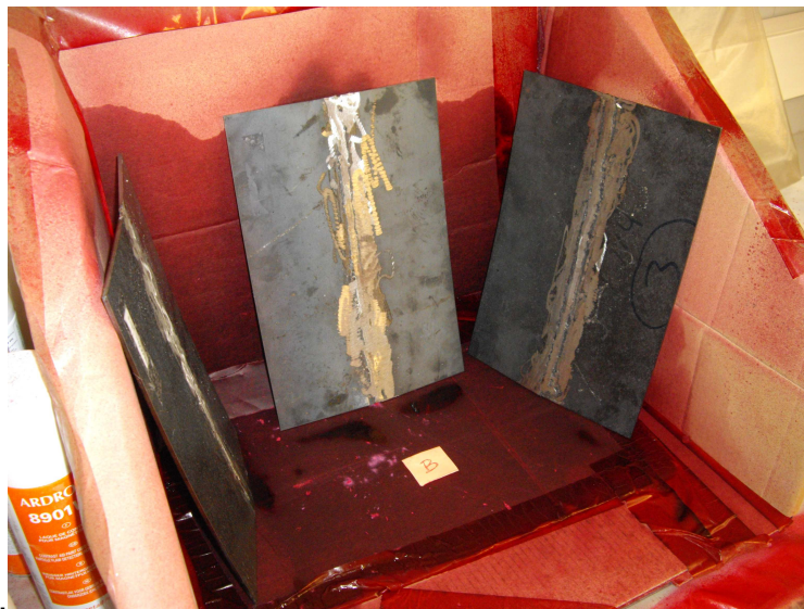
Aplicación de líquidos penetrantes
