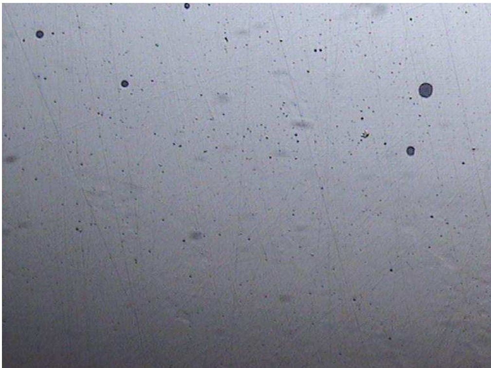
Zona del material de aporte (soldadura) F-1140 con soldadura de electrodo de acero inox. 200
