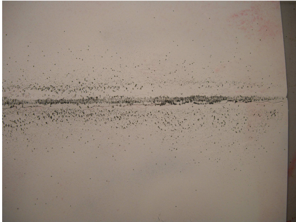
Imagen ampliada de la acumulación de partículas en la soldadura de rutilo
