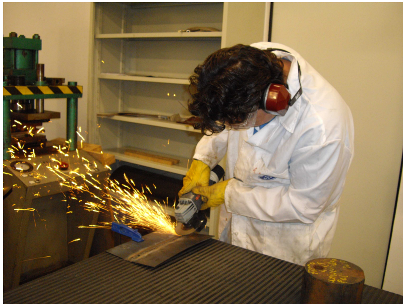
Lijado de la superficie.
