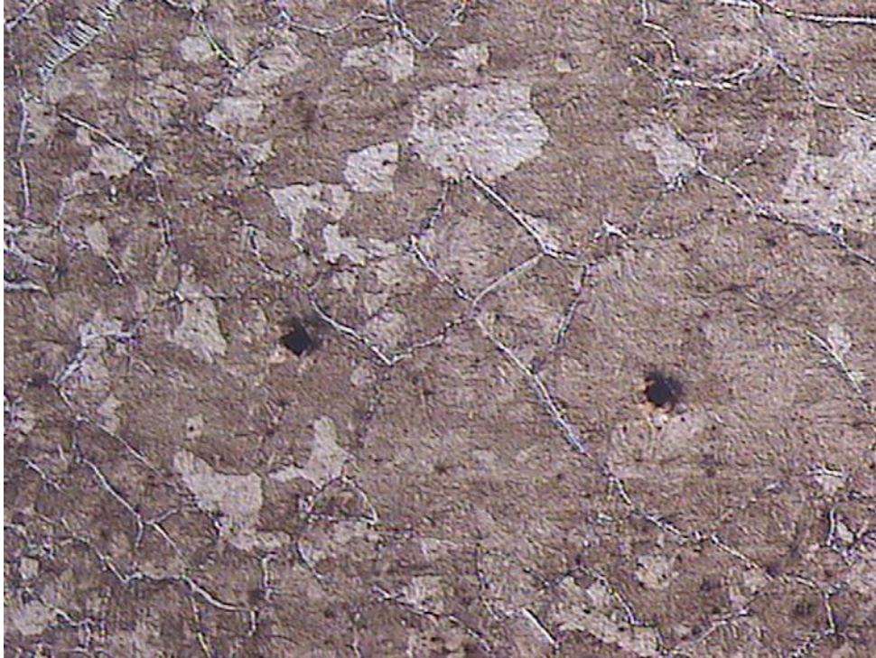
Zona afectada por el calor F-1140 con soldadura de rutilo 50 x
