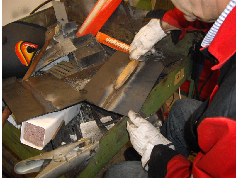
Cepillado para limpieza del cordón de soldadura
