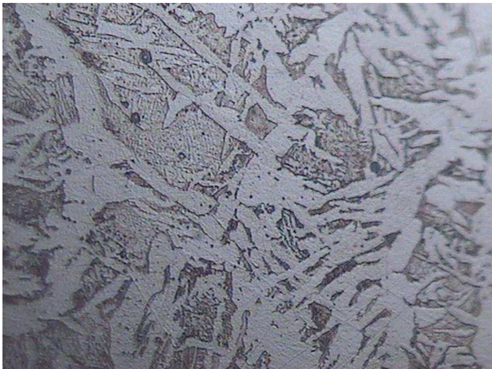
Zona del material de aporte (soldadura) F-1140 con soldadura de rutilo 100 x
