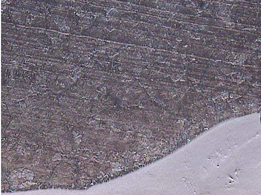
Zona afectada por el calor F-1140 con soldadura de electrodo de acero inox. 50 x
