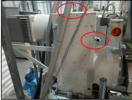
Figura 65. (O) Visor y tapón entrada aceite.
