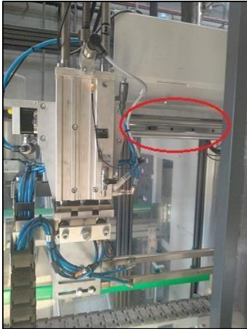
Figura 60. (I) Corredera guía pinzas.
