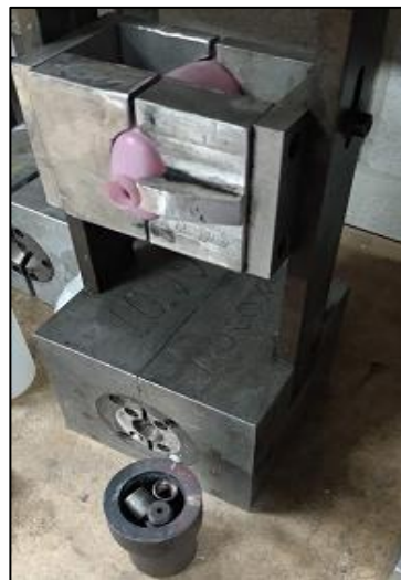
Figura 2. Molde, hilera, puntero, envase.
