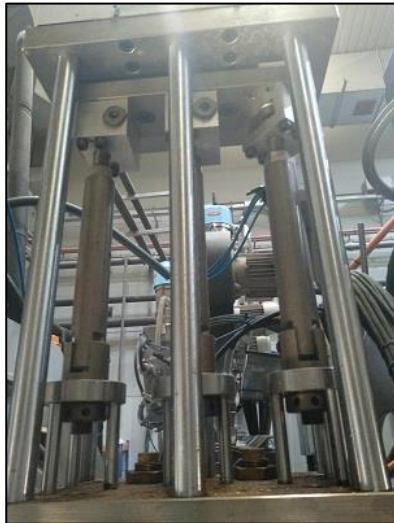
Figura 57. (G) Cilindros del cabezal de inyección.
