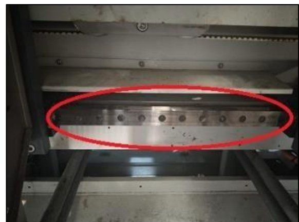
Figura 52. (B) Carro, guía inferior.
