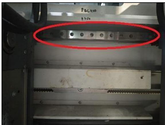
Figura 51. (A) Carro, guía superior.
