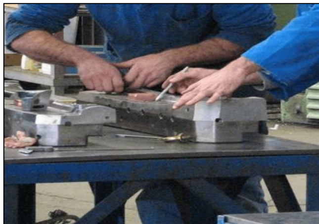
Figura 33. Técnico desmontando un molde.
