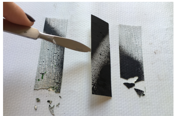
Fig. 32 Comprobación de la adhesión del Acril Me, Aquazol 200 y Beva D-8-S respectivamente.
