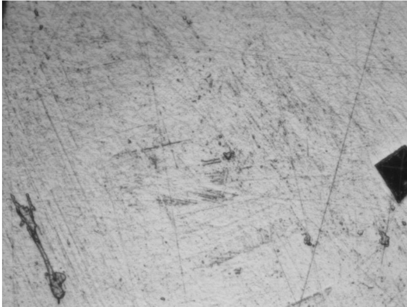
ILUSTRACIÓN 45: imagen del microscopio de la probeta a 200 aumentos en la parte de la soldadura. Caso 3.
