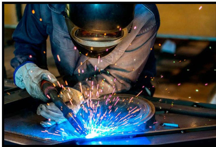
ILUSTRACIÓN 1: soldador con EPI's pertinentes realizando una soldadura por arco de plasma (PAW)
