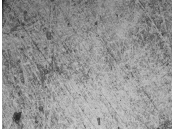
ILUSTRACIÓN 39: imagen del microscopio de la probeta a 200 aumentos en la parte de la soldadura. Caso 1.
