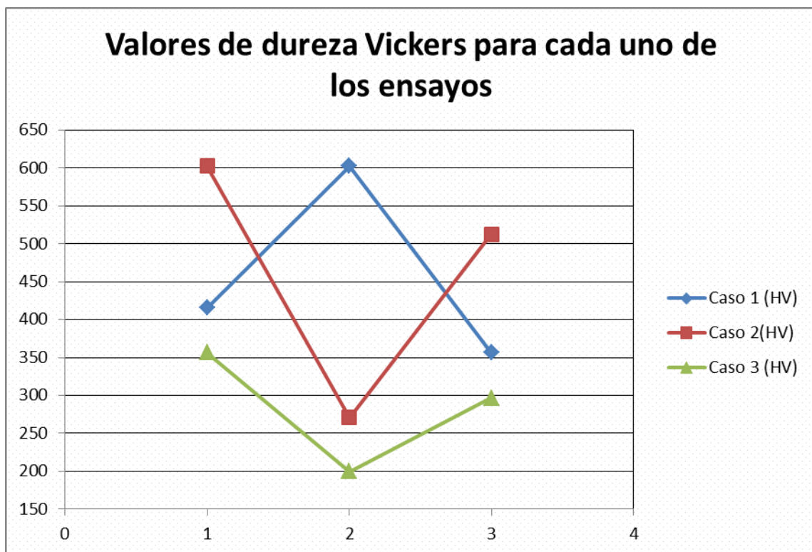
ILUSTRACIÓN 36: comparación de los resultados obtenidos en los ensayos de microdurezas para cada uno de los ensayos realizados en cada una de las partes de las probetas (1,2,3)
