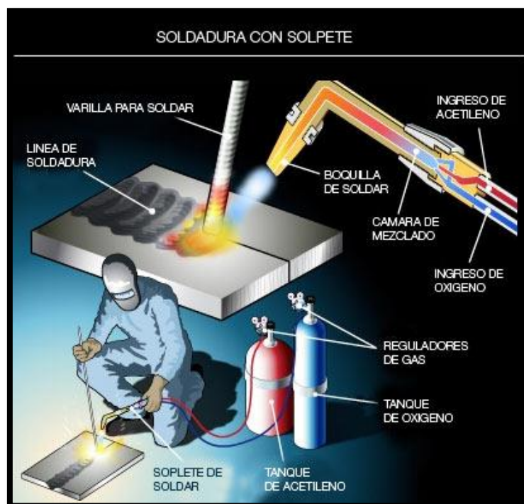
ILUSTRACIÓN 8: Soldadura con oxiacetileno
