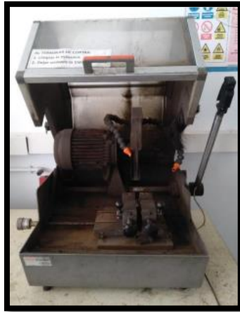
ILUSTRACIÓN 25: tronzadora refrigerada con taladrina
