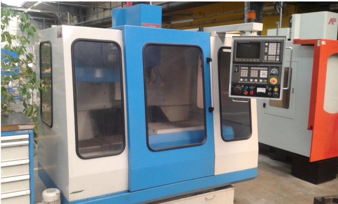
Figura 72: Centro de mecanizado fresadora Kondia B500
