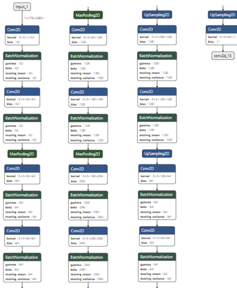
Figura 3.1: Autoencoder destinat al preentrenament amb les imatges ADNI en 2D per a utilitzar els seus pesos calculats com a ajuda a altres xarxes neuronals encarregades de la classificació.
