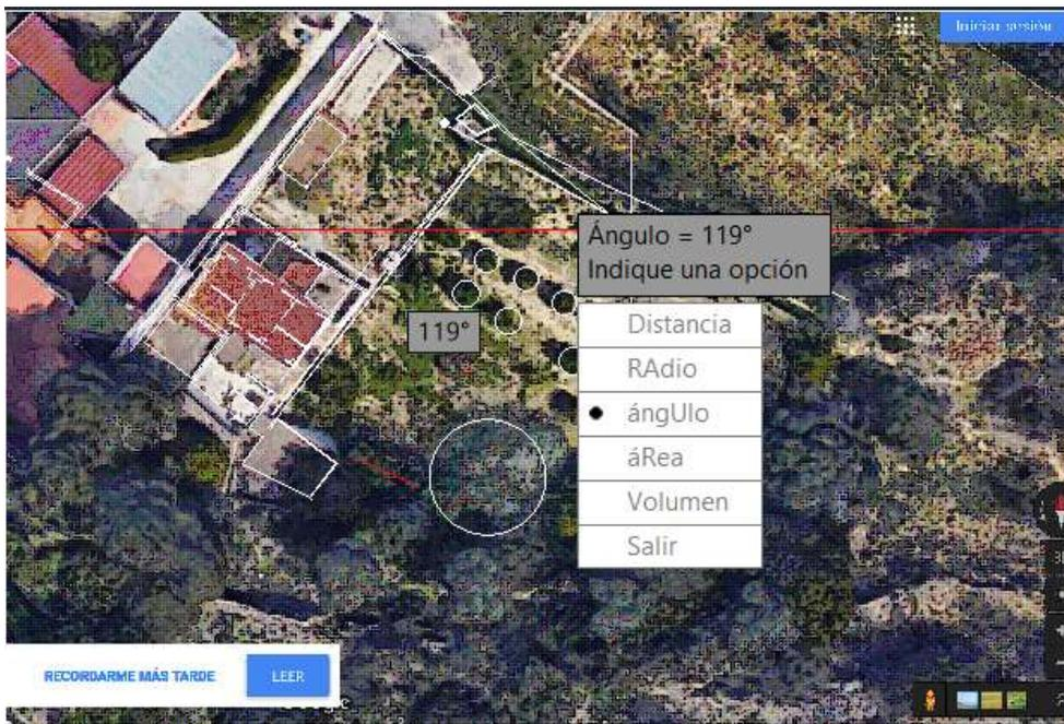
Imagen 17. Ángulo que forma la orientación de los paneles con el muro por la parte derecha, Acimut de  $+119^\circ$
