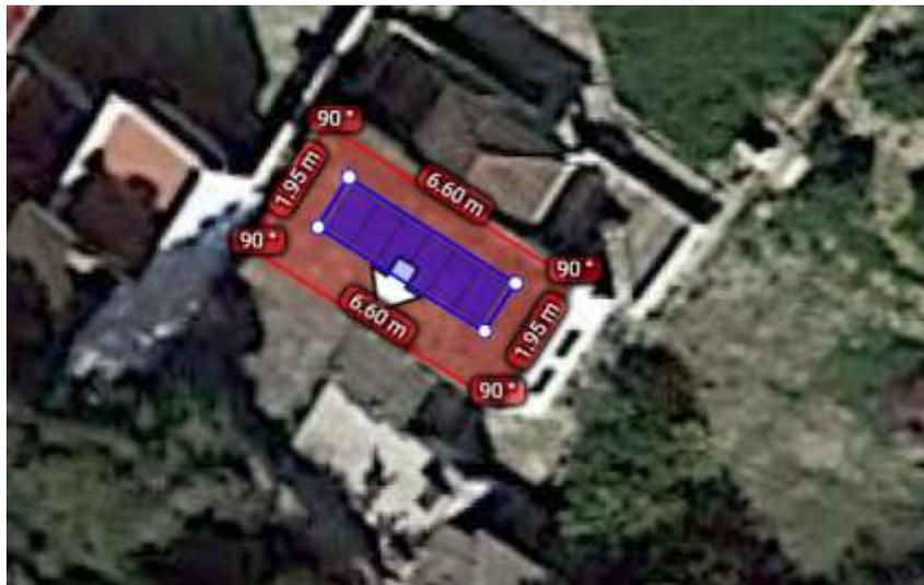
Imagen 29. Superposición de 6 paneles fotovoltaicos en el tejado real
