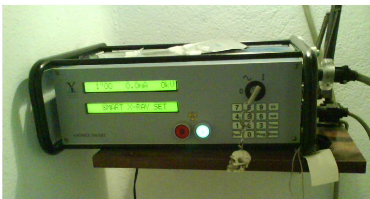
Alimentación y control de la maquina de rayos X
