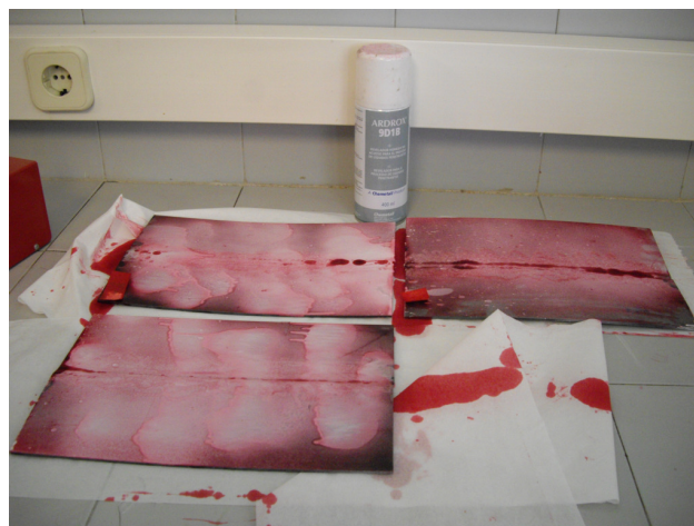
Chapas cubiertas de líquido revelador.
