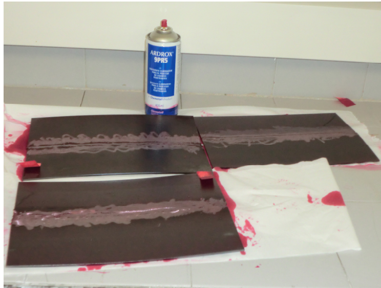
Eliminación del penetrante superficial.
