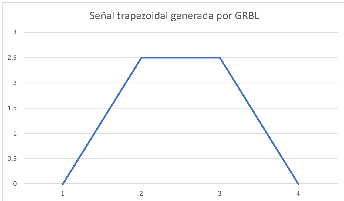
Figura 57. Señal trapezoidal emitida por GRBL.
