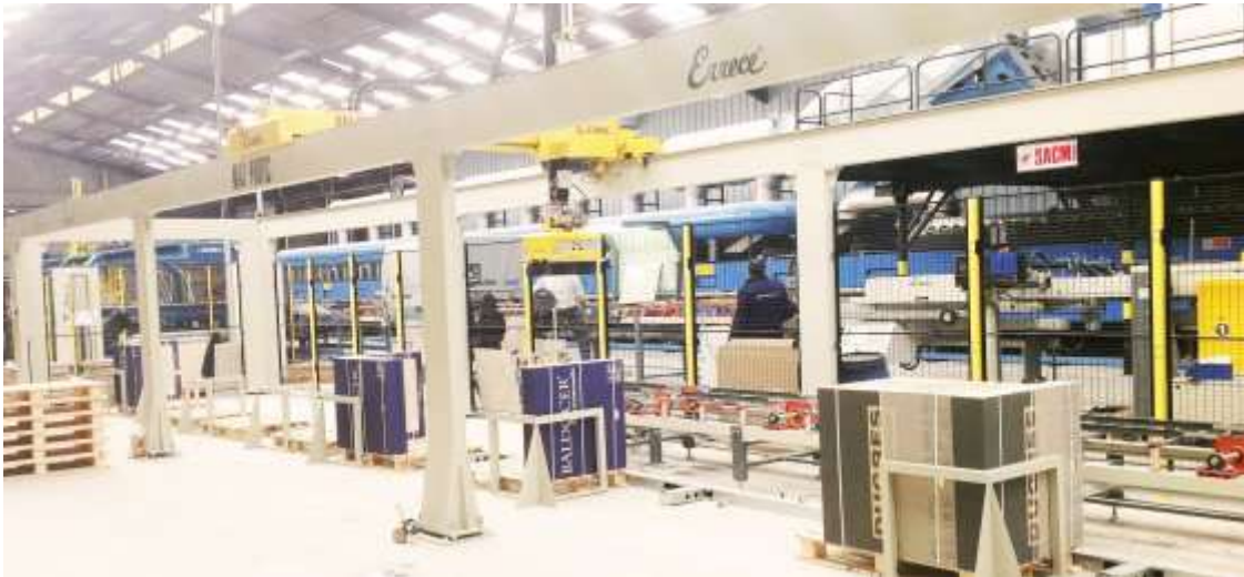
Figura 1. Pórtico en una empresa de cerámica.
