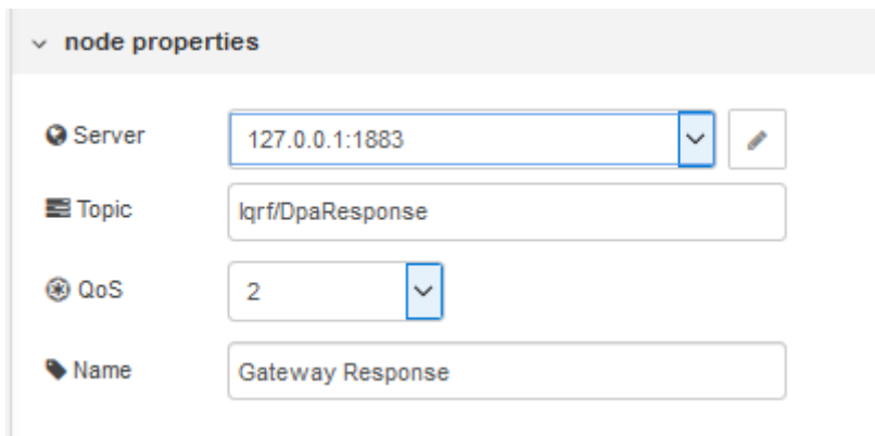
Ilustración 49 - Bloque de Entrada MQTT
