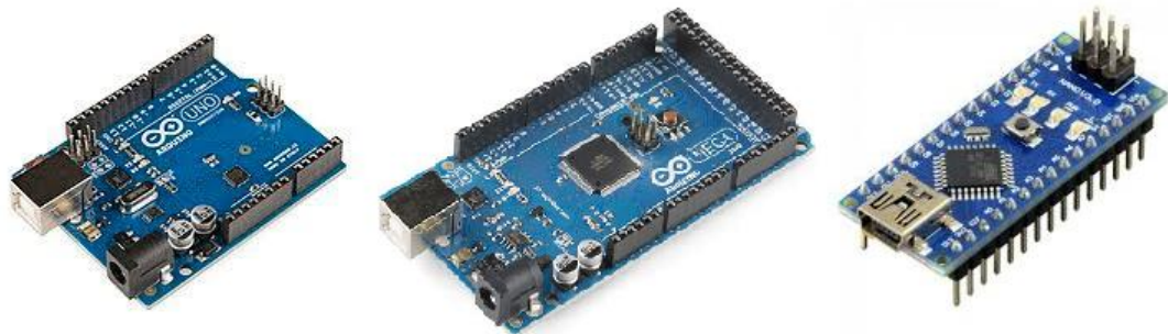
Ilustración 6 - Placas Arduino UNO, MEGA y Nano
