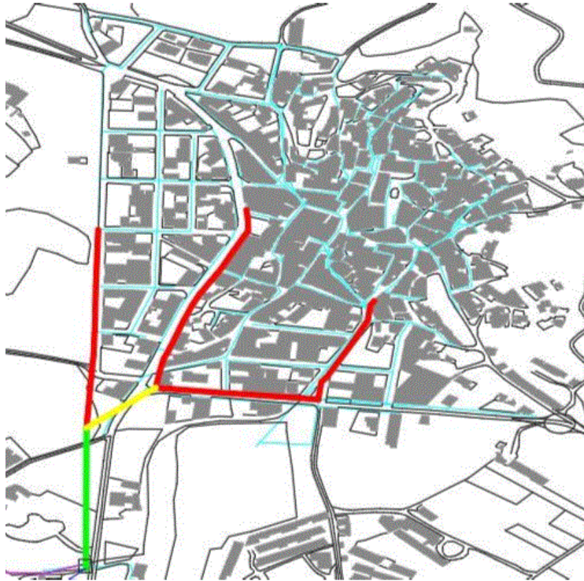
Ilustración 15: Red de saneamiento por diámetros.
