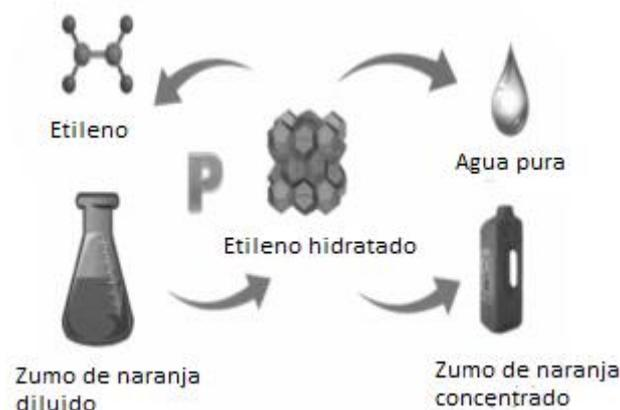
*Figura 2.10: Mecanismo de separación por compuestos hidratados*
