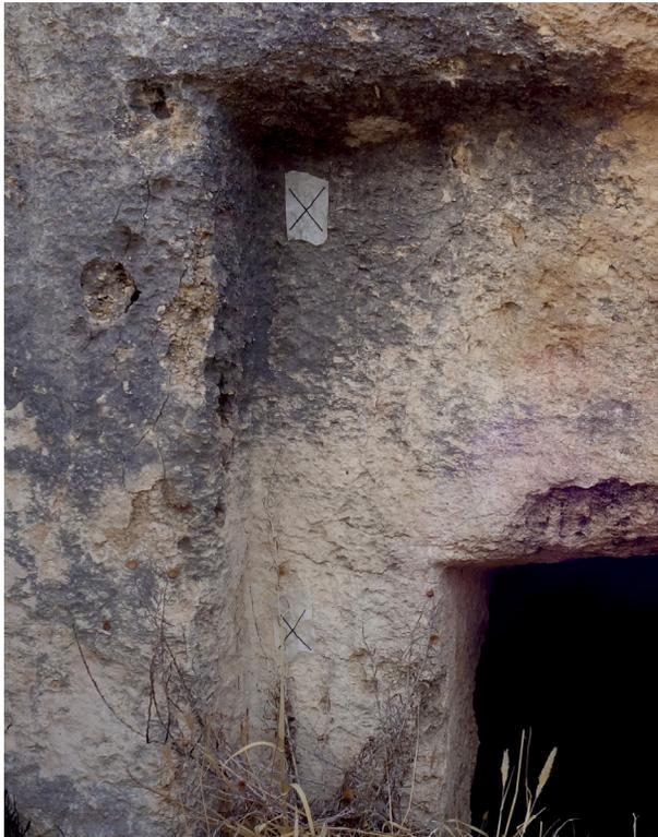
Figura 14. Dianas para la introducción de datos al software, reorientando la imagen. Fuente: S. Manzano.
