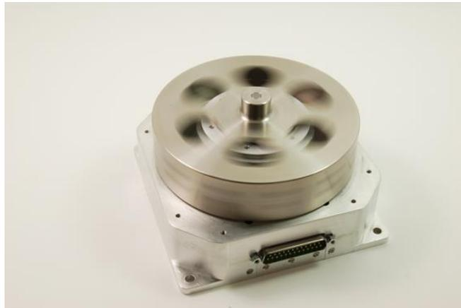
Figura 8 - Rueda de reacción con motor y estructura de montaje
