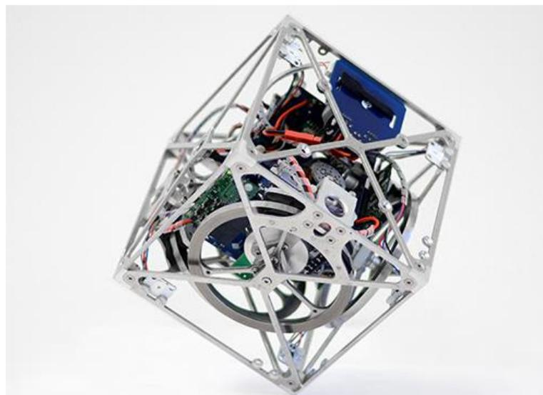
*Figura 13 - El Cubli balanceándose sobre una de sus esquinas*
