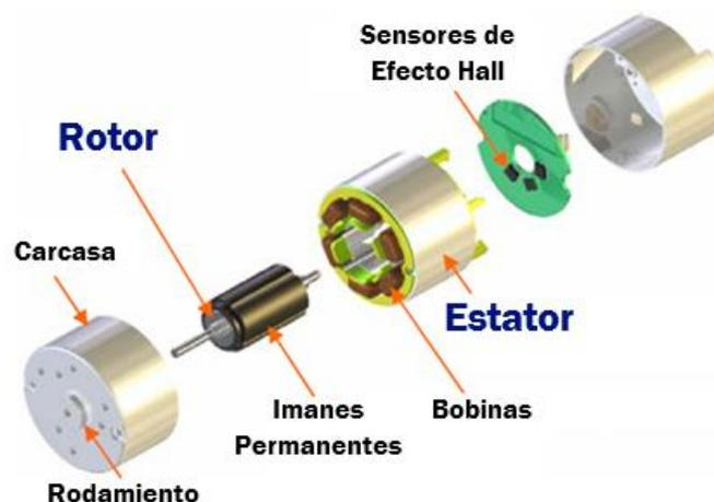
Figura 18 - Motor CC sin escobillas sensorizado
