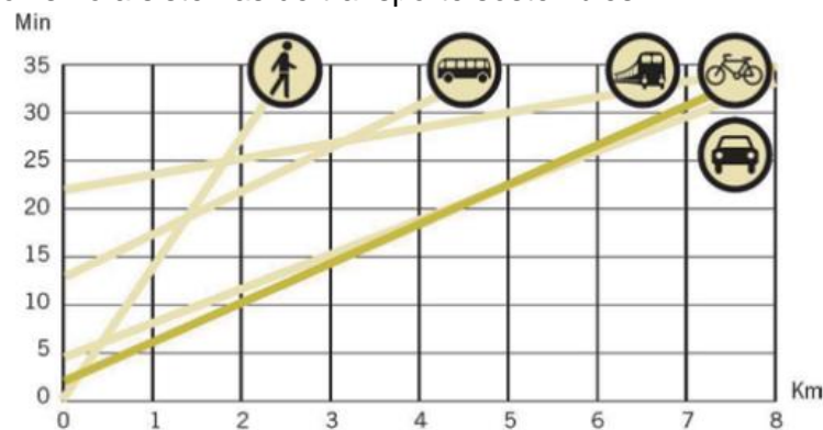
Figura 2. Distancia vs Tiempo de acuerdo a los diferentes medios de transporte. Fuente: "Cycling: the way ahead for towns and cities (1999). European Commission
