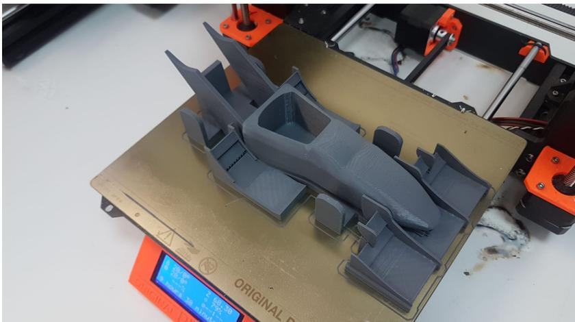
**Figura 8.5:** Resultados de la impresión del FSUPV-03
