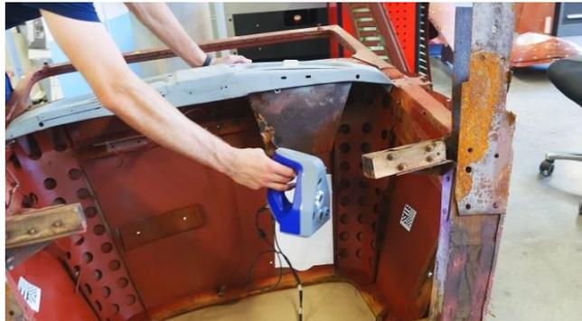
**Figura 7.1:** Escaneo del automóvil mediante el láser escáner Space Spider
