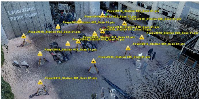
**Figura 5.22:** Vista con fotografía y con posiciones y números de estacionamiento
