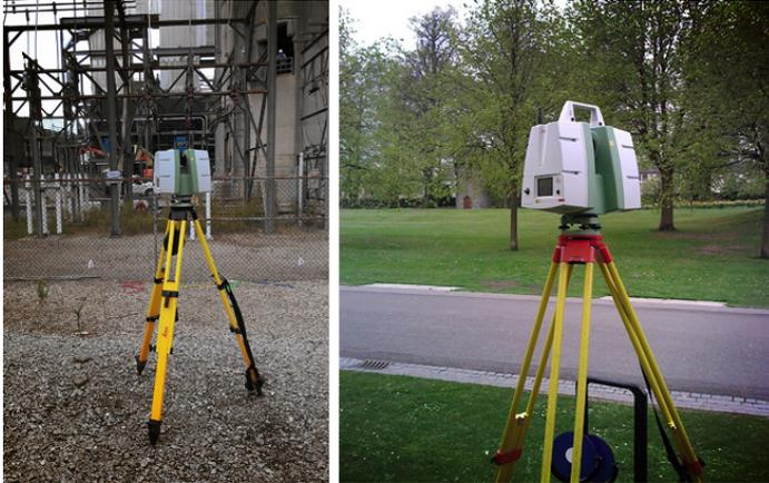
Figura 2.1: Ejemplo de un láser escáner
