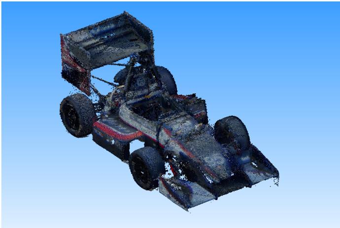
**Figura 6.1:** Vista de la nube de puntos del coche 02 en 3DReshaper
