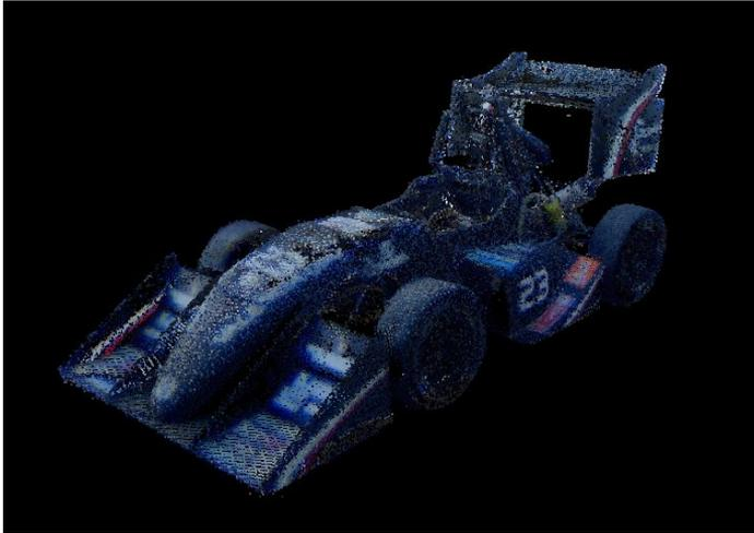
**Figura 5.28:** Nube de puntos del FSUPV-01 después de la limpieza
