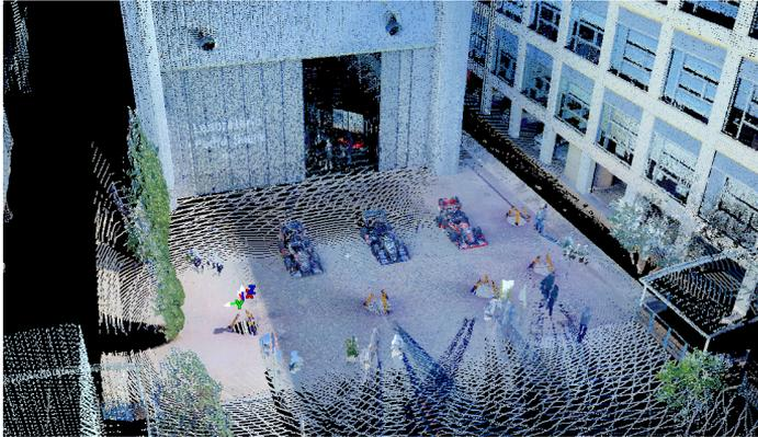
**Figura 5.17:** Vista de la unión de los escaneos del 1 al 5 con los datos tomados por la cámara
