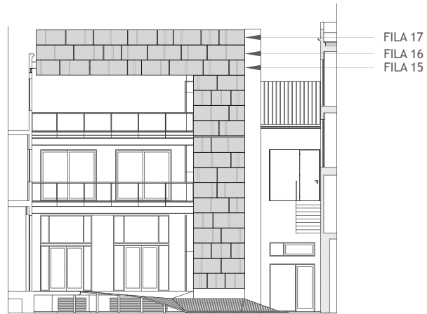
ALZADO FACHADA NE REPLANTEO BASTIDORES
