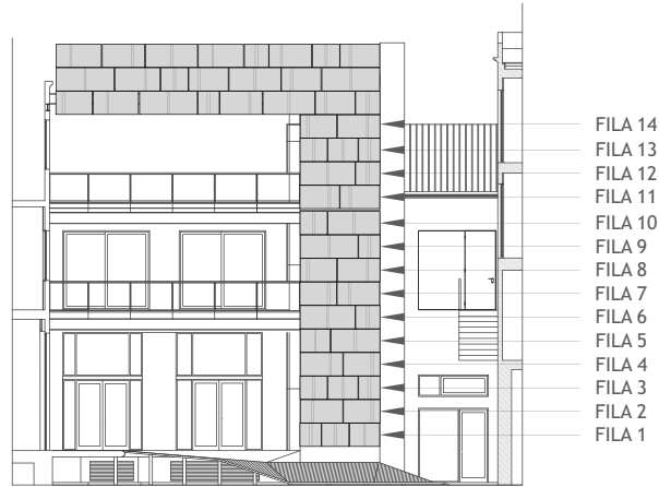
ALZADO FACHADA NE REPLANTEO BASTIDORES
