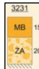
Figura 6: Firme escogida (Norma 6.1-IC)
