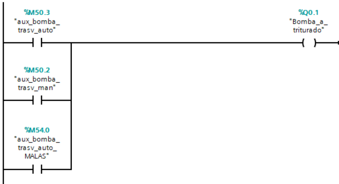
Figura 53 Programación segmento 10 "Activación_actuadores"
