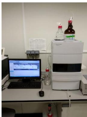
Figura 14. Dispositivo HPLC y programa informático de análisis
