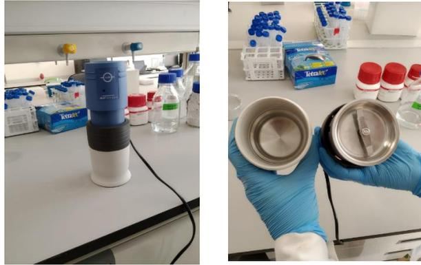
Figura 11a. Molino triturador de muestras. 11b. Cuchilla interior del molino triturador
