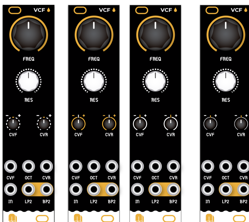
Imagen 73. Propuestas de diseño para las coronas de attenuverters en la interfaz de FONT. Numeración de izquierda a derecha (Opción 1, 2, 3...)
