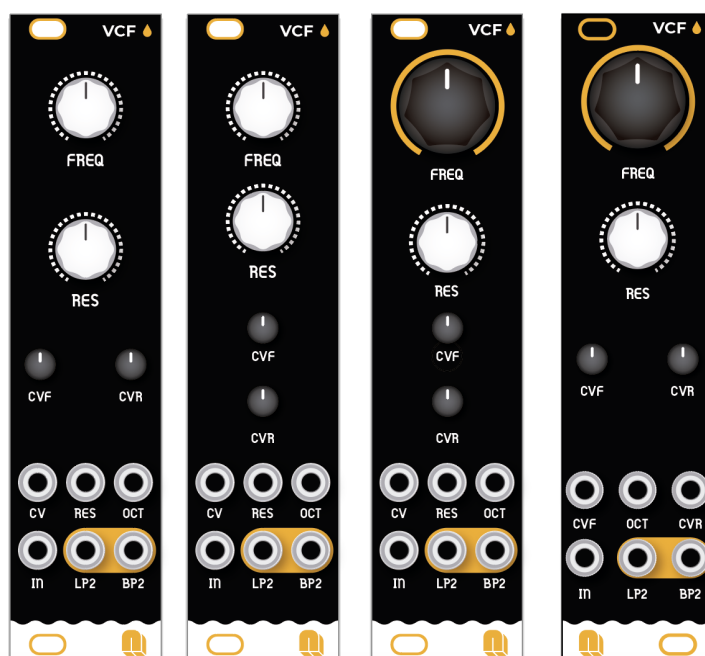
Imagen 72. Opciones de distribución y tipo de los componentes para la Segunda versión de FONT. Numeración de izquierda a derecha (Opción 1, 2, 3...)
