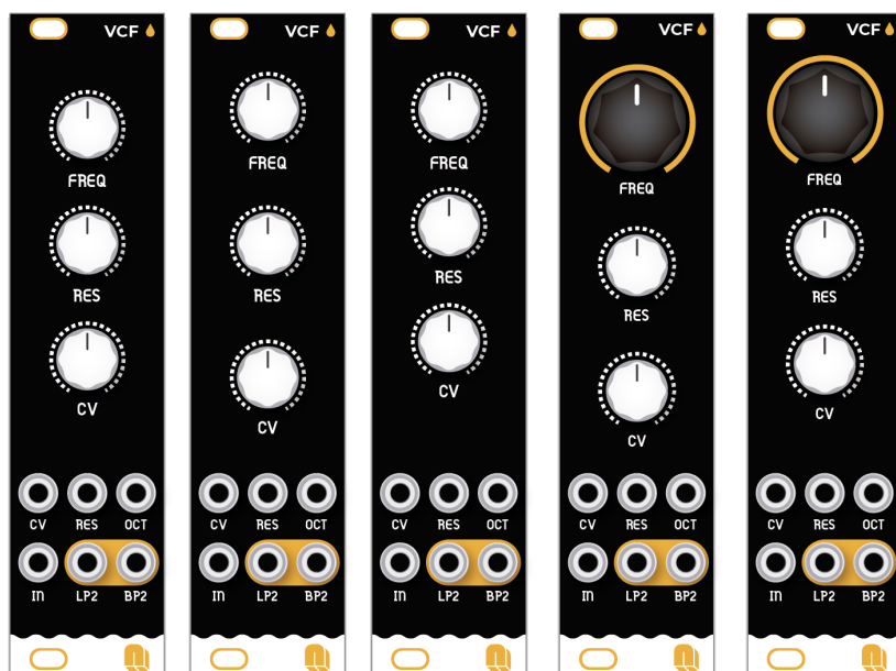
Imagen 71. Opciones de distribución y tipo de los componentes para la Primera versión de FONT. Numeración de izquierda a derecha (Opción 1, 2, 3...)
