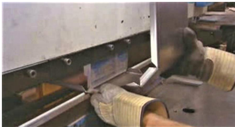
Ilustración 7. Tarea de prensado. Fuente: [30]
