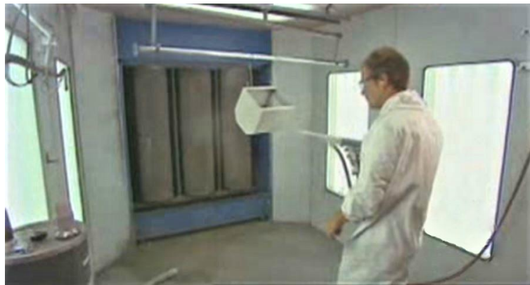
Ilustración 8. Tarea de pintado electrostático. Fuente: [30]
