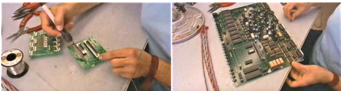
Ilustración 10. Tarea de ensamblaje de circuitos de la placa y el controlador. Fuente: [30]
