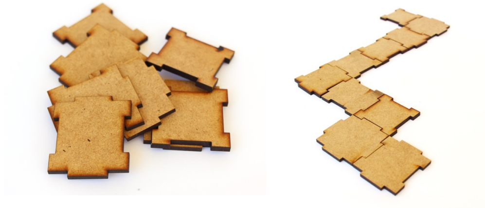
Fig.28., Fig.29. Maqueta, piezas DM, cortadas a laser.
