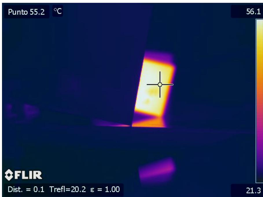
*Termografía 60. Test de opacidad al infrarrojo para la placa de polipropileno.*
