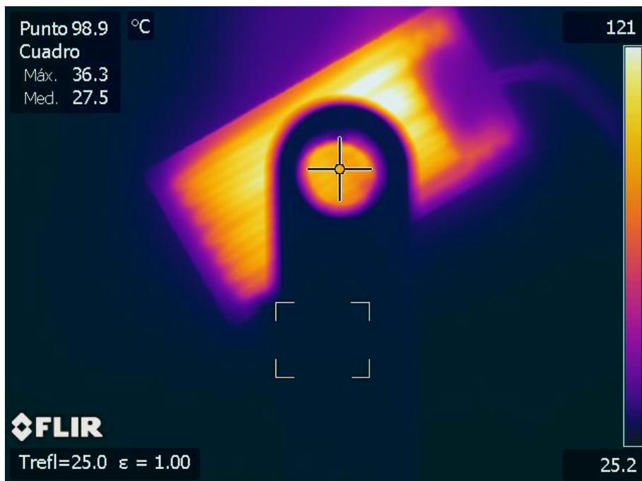
Termografía 72. Medida de la transmisividad del NaCl recubierto con Parafilm a 113 °C.
