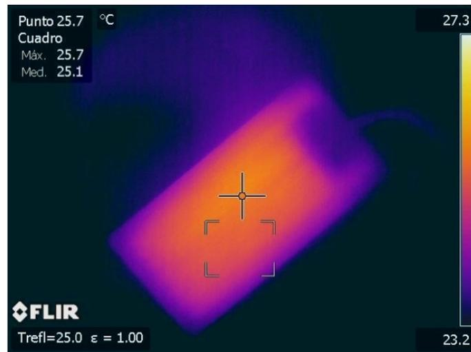
Termografía 25. Medida de la temperatura de la resistencia a 25,7 °C.
