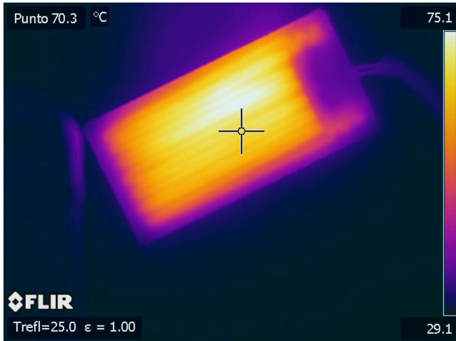
*Termografía 105. Medida de la temperatura de la resistencia a 70,3 °C.*
