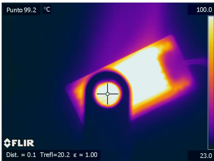
Termografía 86. Medida de la transmisividad del NaCl recubierto con Polietileno a 113 °C.
