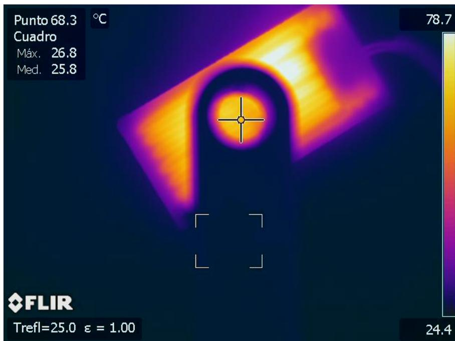
Termografía 66. Medida de la transmisividad del NaCl recubierto con Parafilm a 76,4 °C.
