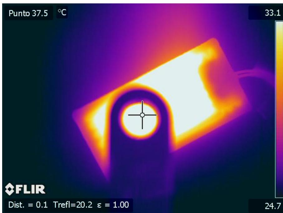
Termografía 76. Medida de la transmisividad del NaCl recubierto con Polietileno a 37,5 °C.
