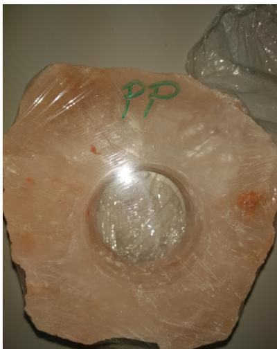
Ilustración 9. Superficie inicial de roca de sal recubierta de lámina de PE.
