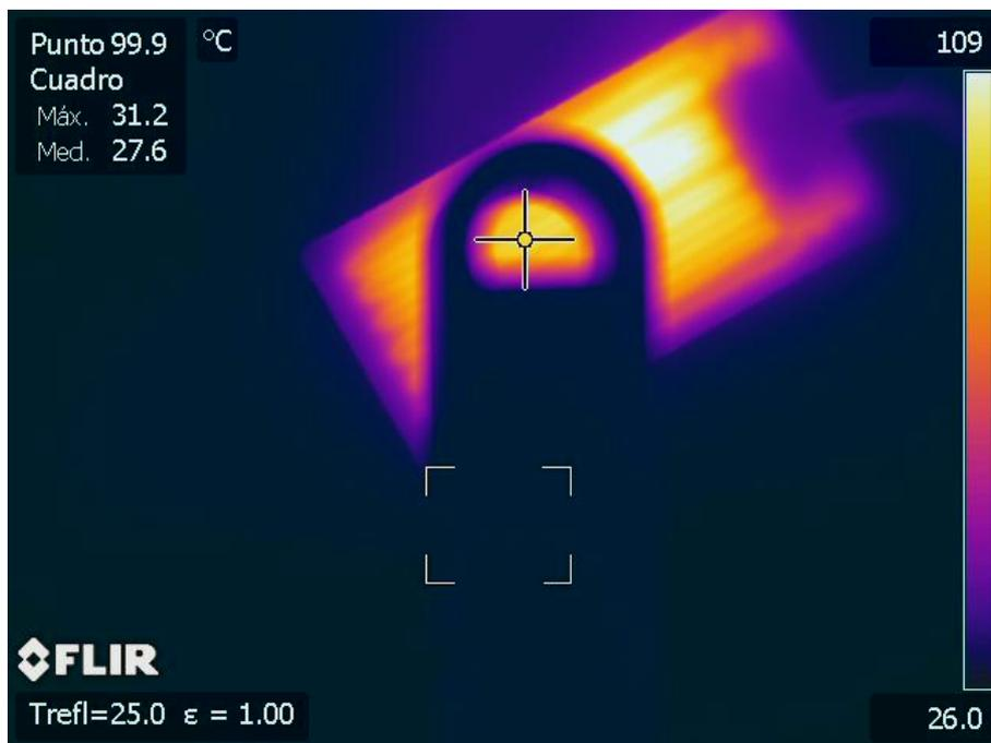
Termografía 102. Medida de la transmisividad del cristal de NaCl de 8 mm a 110 °C.
