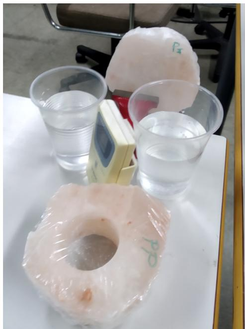
*Ilustración 12. Montaje del ensayo dentro del recipiente, para lograr un ambiente húmedo (alrededor del 80%).*
