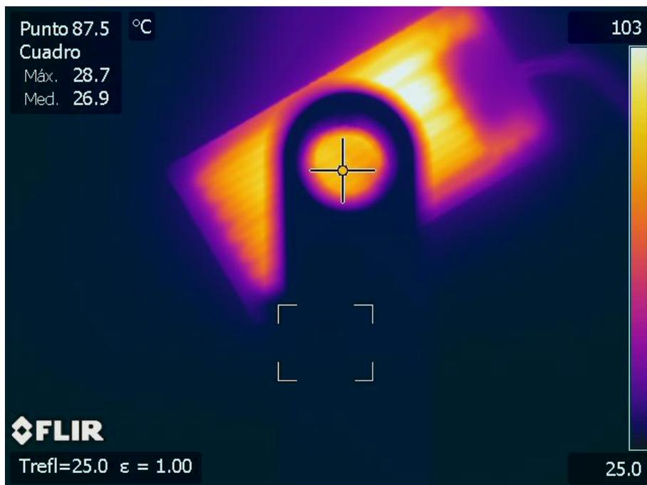
Termografía 70. Medida de la transmisividad del NaCl recubierto con Parafilm a 98 °C.
