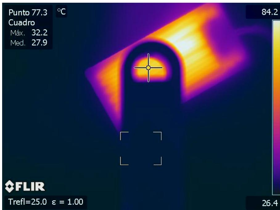
Termografía 100. Medida de la transmisividad del cristal de NaCl de 8 mm a 85,3 °C.
