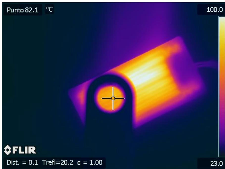
Termografía 82. Medida de la transmisividad del NaCl recubierto con Polietileno a 90,5 °C.
