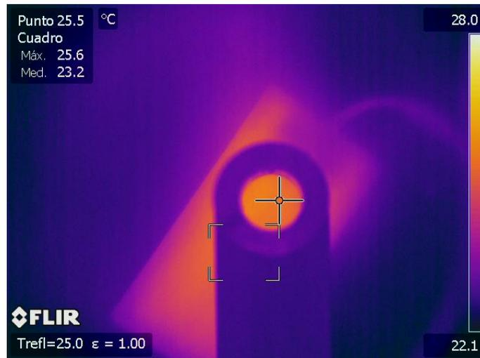
*Termografía 9. Medida de la temperatura de la resistencia a 25,5 °C.*
