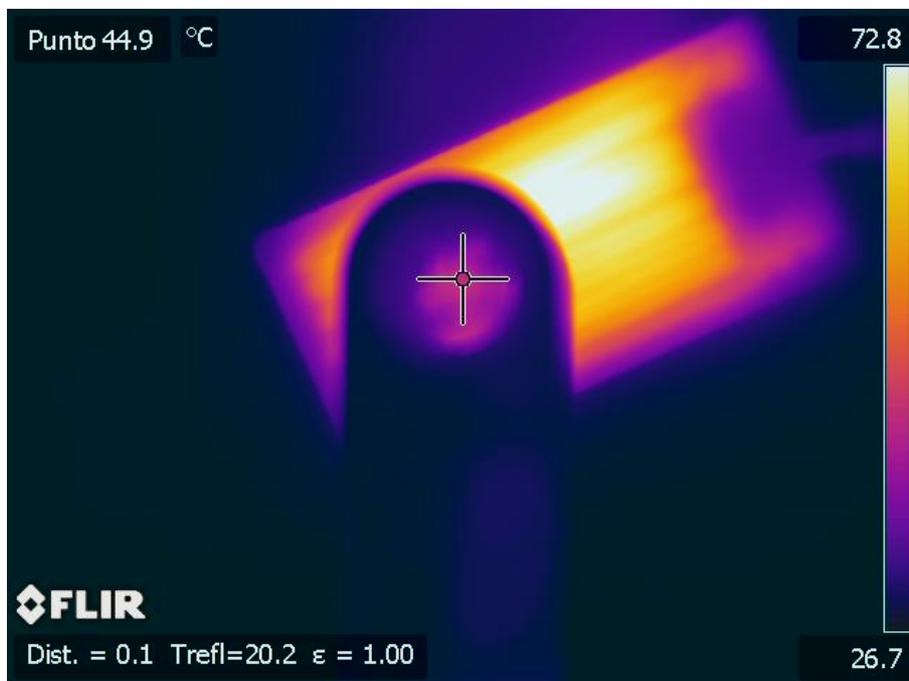
Termografía 110. Medida de la transmisividad del cristal de NaCl recubierto con 0,66 mm de Parafilm, a 70,1 °C.
