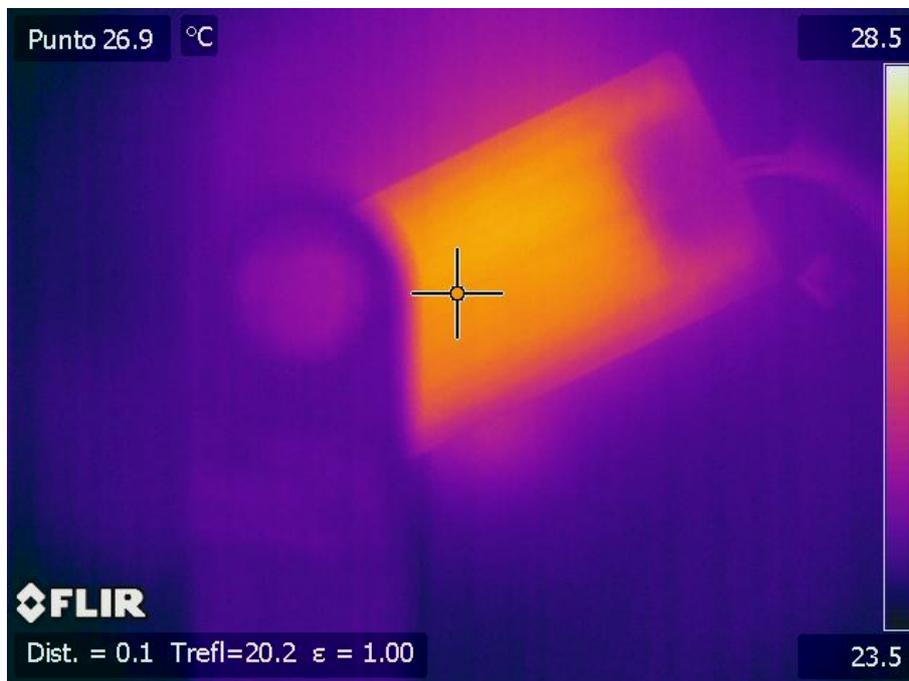
Termografía 87. Medida de la temperatura de la resistencia a 26,9 °C.
