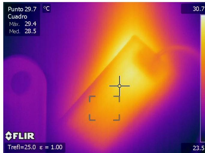
Termografía 17. Medida de la temperatura de la resistencia a 29,7 °C.
