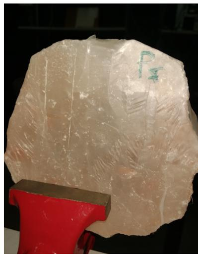
Ilustración 10. Superficie inicial de roca de sal recubierta con Parafilm.
