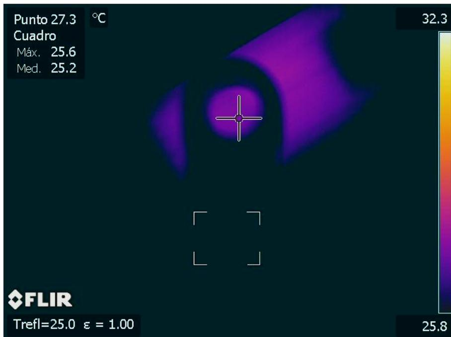
Termografía 62. Medida de la transmisividad del NaCl recubierto con Parafilm a 27,3 °C.
