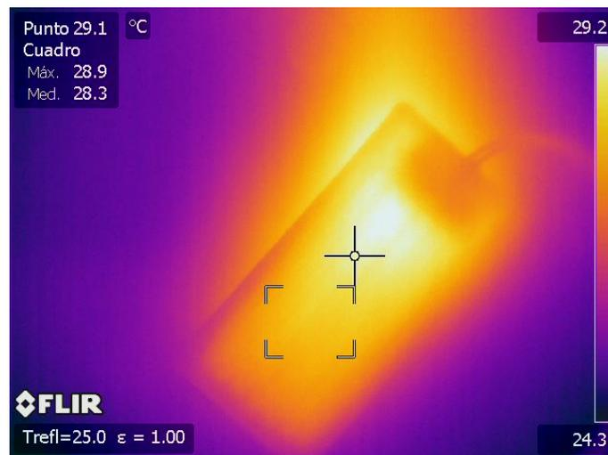
Termografía 1. Medida de la temperatura de la resistencia a 29,1 °C..
