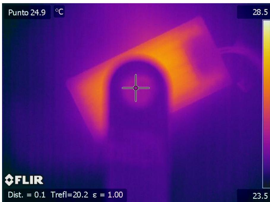
Termografía 88. Medida de la transmisividad del NaCl recubierto con Cinta adhesiva a 26,9 °C.
