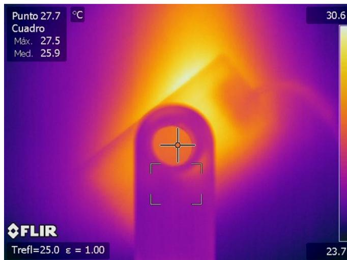
Termografía 42. Medida de la transmisividad del CaF<sub>2</sub> a 29,5°C.
