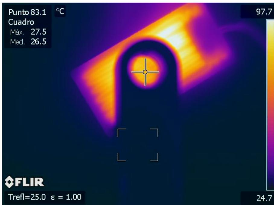
Termografía 68. Medida de la transmisividad del NaCl recubierto con Parafilm a 93,3 °C.
