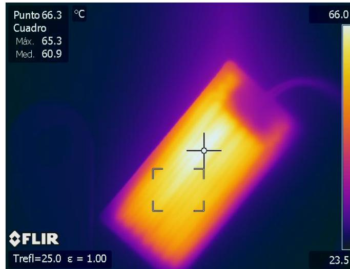
Termografía 21. Medida de la temperatura de la resistencia a 66,3 °C.
