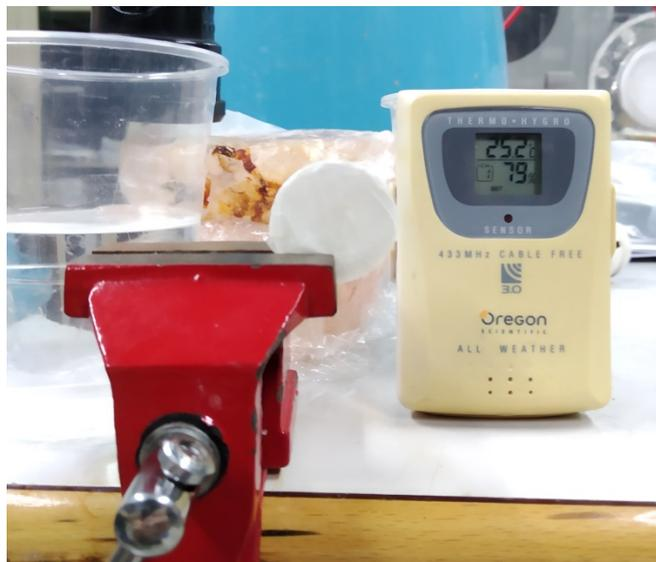
*Ilustración 13. Disposición de la lente de cloruro sódico en ambiente cerrado con una humedad relativa del 79%.*
