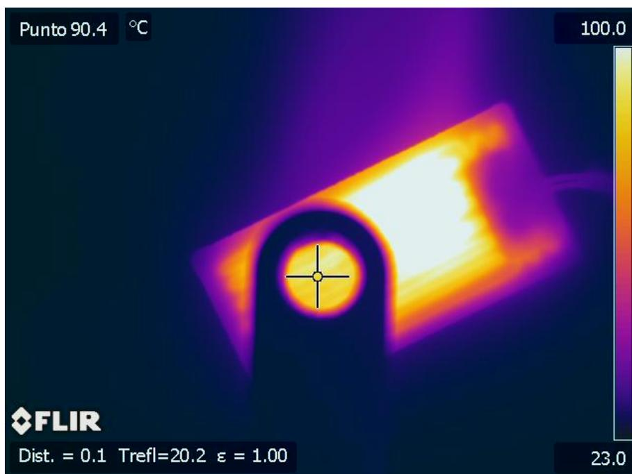
Termografía 84. Medida de la transmisividad del NaCl recubierto con Polietileno a 102 °C.
