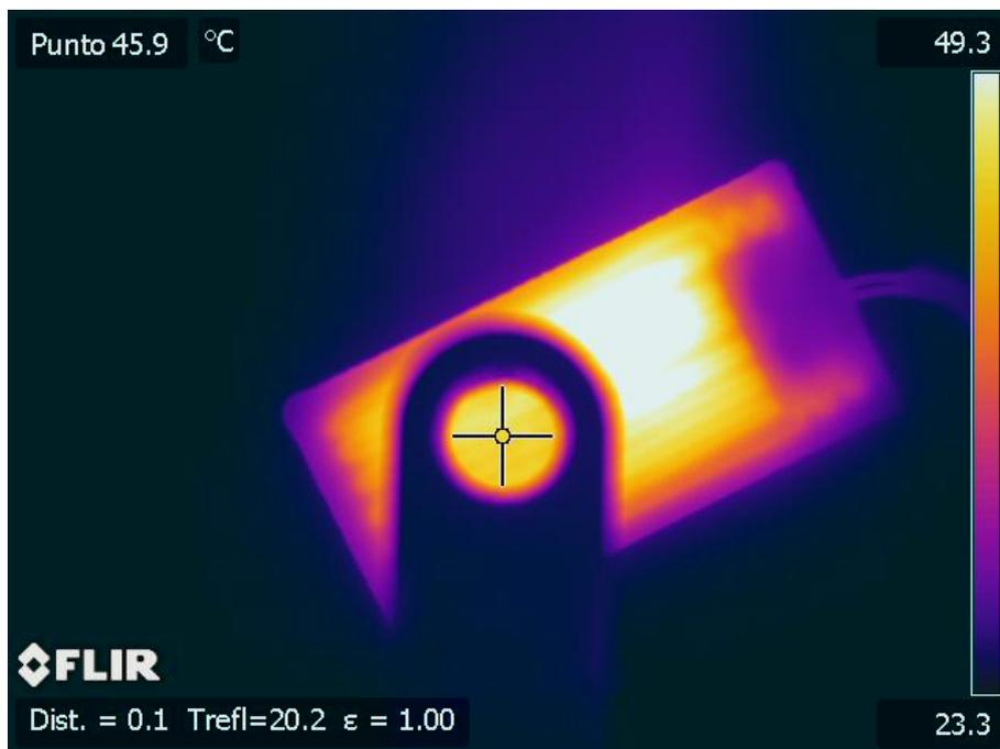
Termografía 78. Medida de la transmisividad del NaCl recubierto con Polietileno a 50,3 °C.
