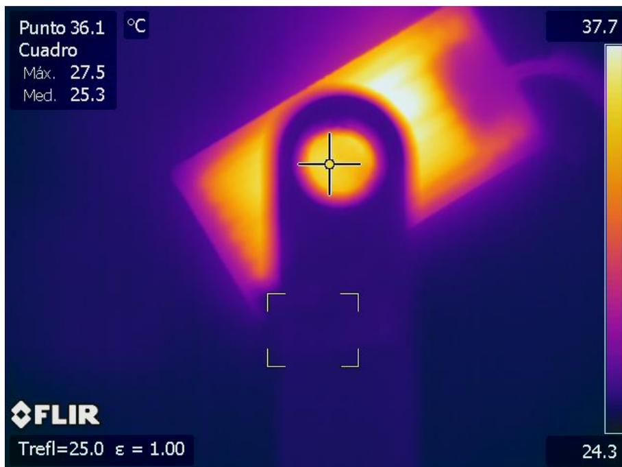
Termografía 64. Medida de la transmisividad del NaCl recubierto con Parafilm a 36,1 °C.
