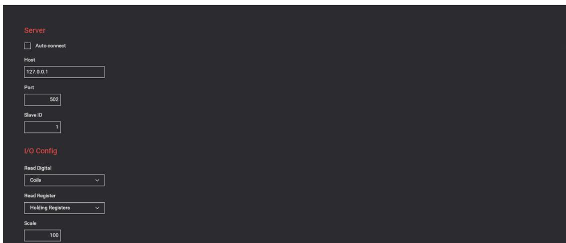
Figura 29 - Configuración Conexión Factory IO
