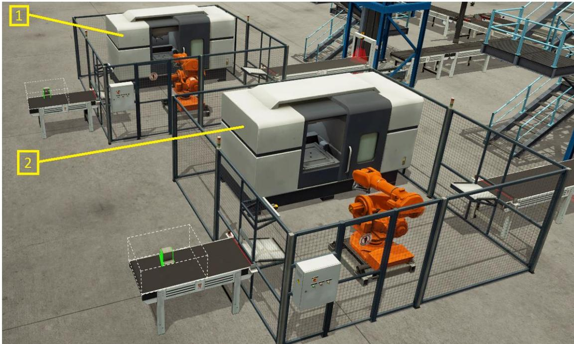
Figura 2, Elaboración Propia, Centros de Mecanizado. 1.Producción de Bases / 2. Producción de Tapas
