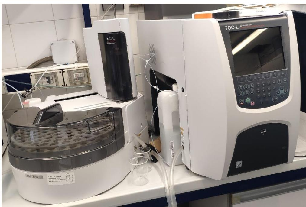
**Figura 13.** Analizador de carbono orgánico total TOC-L de Shimadzu.
