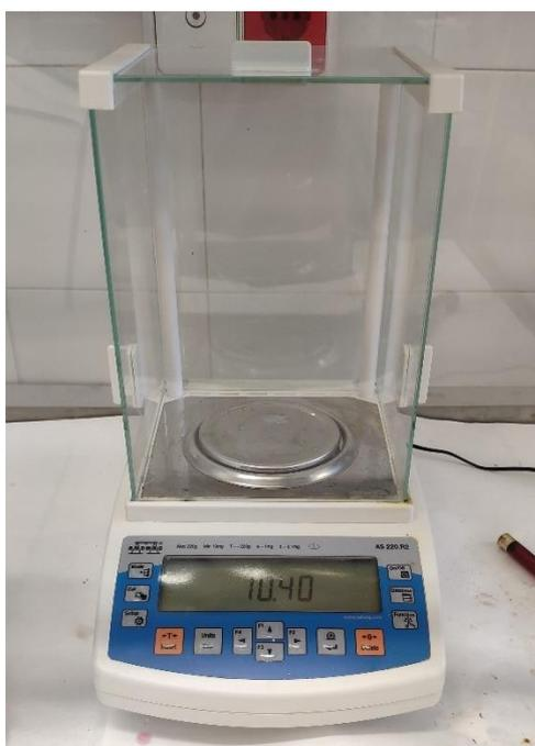
**Figura 6.** Balanza analítica empleada para la preparación de las disoluciones.
