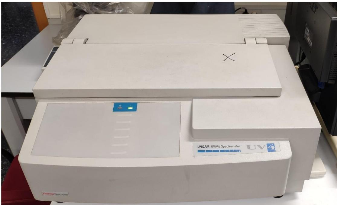
**Figura 10.** Espectrofotómetro UV/Vis UV 4 de ThermoSpectronic.
