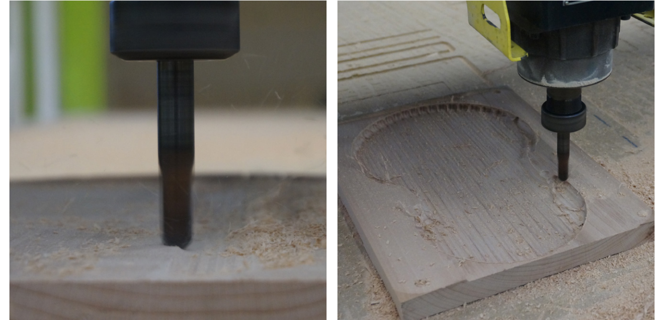
Figuras 206 y 207. Fresado de desbaste del interior del modelo RDG (Fotos: B. Oria)
