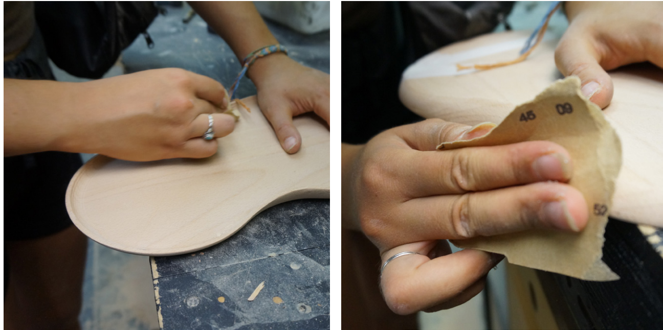
Figuras 218 y 219. Lijado manual del producto terminado (Fotos: D. Fernández)
