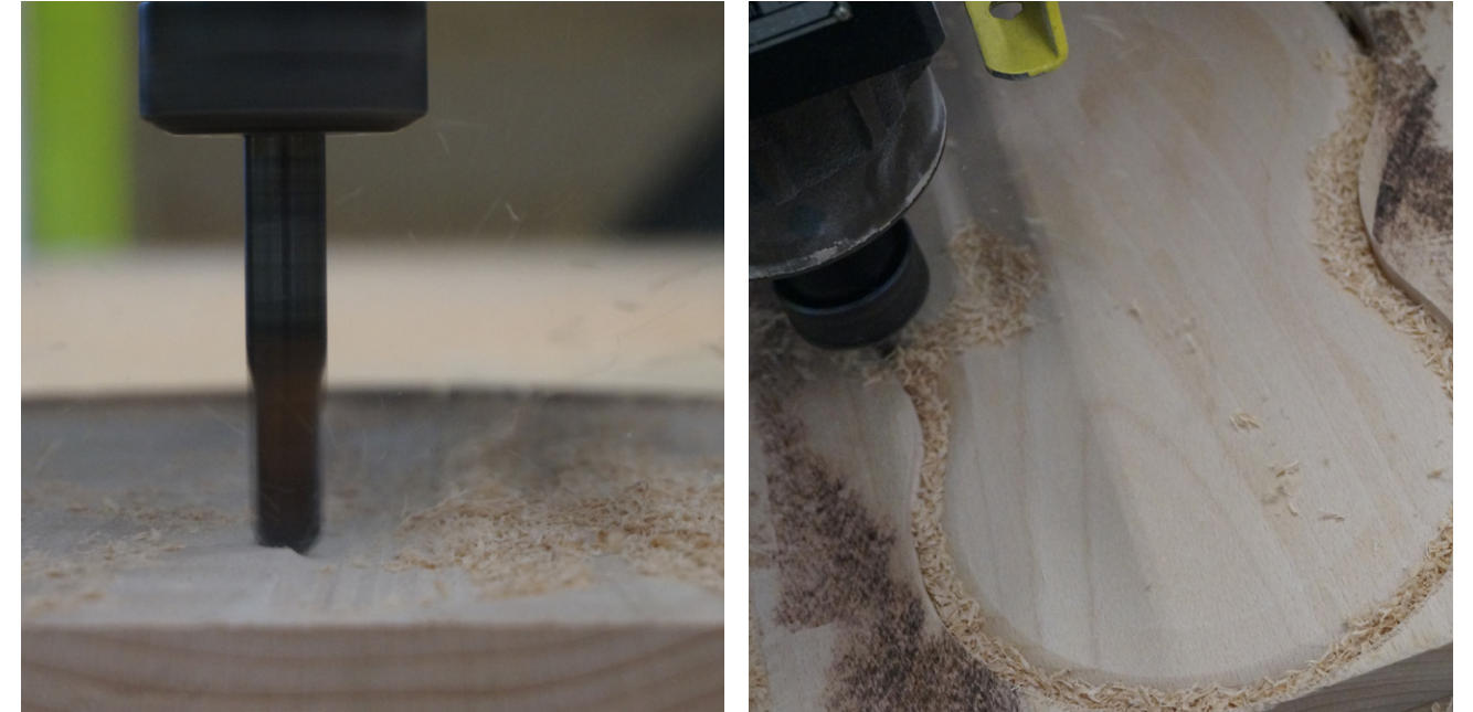
Figuras 214 y 215. Fresado de desbaste del reverso del modelo RDG (Fotos: B. Oria)
