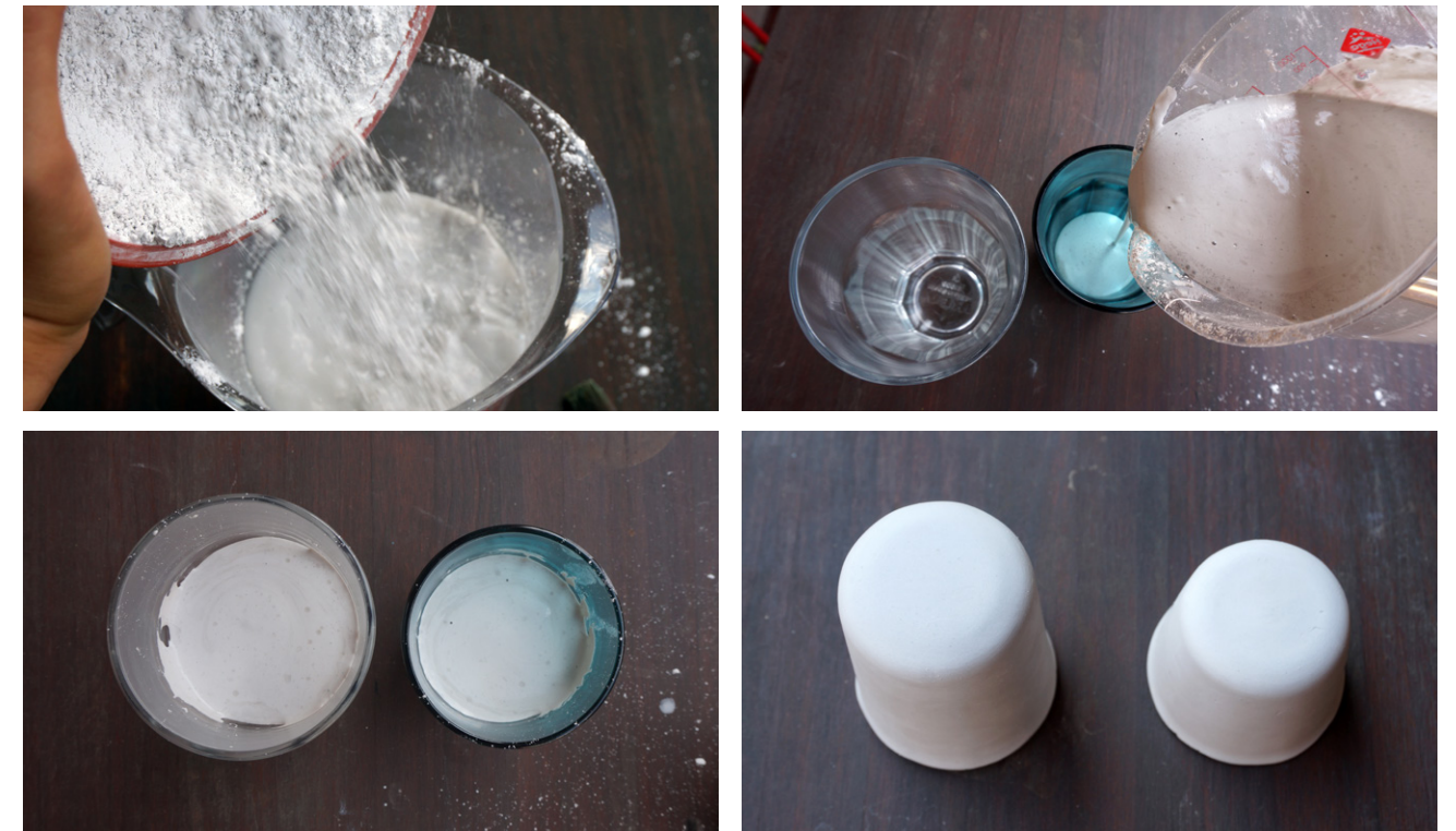
Figuras 181, 182, 183 y 184. Fabricación del molde de escayola (Fotos: B. Oria)
