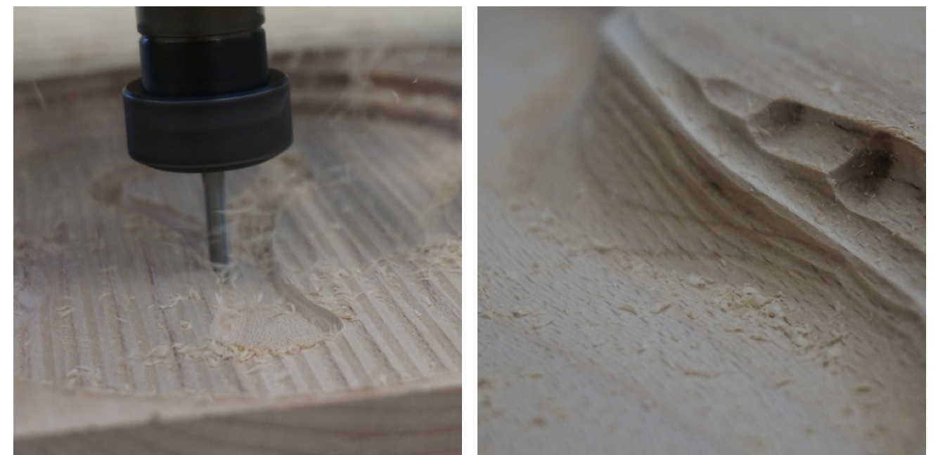
Figuras 208 y 209. Fresado de acabado del interior del modelo RDG (Fotos: B. Oria)
