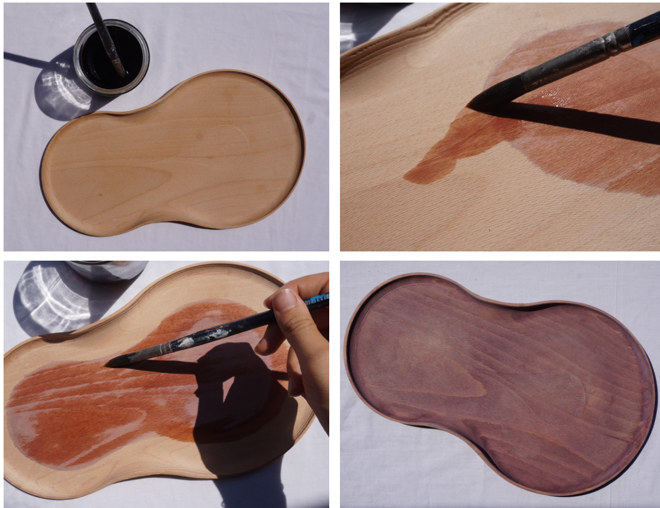
Figuras 224, 225, 226 y 227. Proceso de obtención aplicación del tinte a las bandejas de madera (Fotos: B. Oria)
