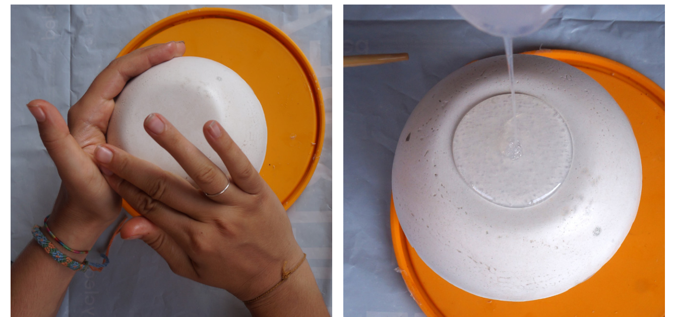
Figuras 191 y 192. Limpieza del molde y vertido de la mezcla sobre el molde (Fotos: B. Oria)
