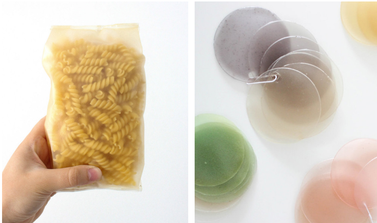
Figuras 113 y 114. Izda.: packaging a base de algas; dcha.: muestras de bioplástico a base de algas (Foto: margaritatalep.com)
