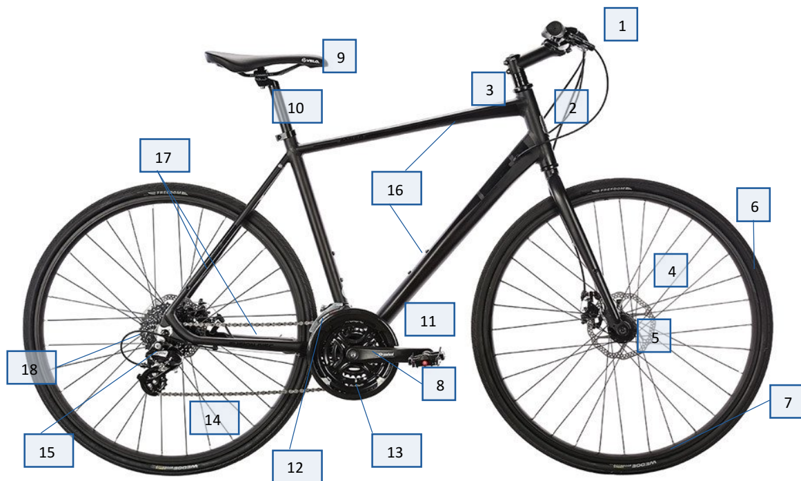
Figura 6: Anatomía de una bicicleta híbrida. Componentes elementales. Fuente: Elaboración propia.
