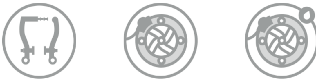
Figura 18: Freno de llanta (izquierda), freno de disco mecánico (medio) y freno de disco hidráulico (derecha).
