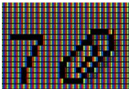
Figura 5. Detalle de un monitor. Se aprecia cada píxel, formado por 3 bandas de color.
