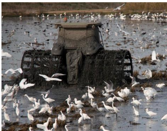
Ilustración 4. Tractor realizando la labor del fangueo. Fuente: Levante EMV.
