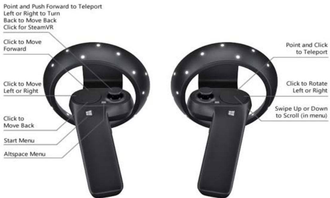
Figura 16 Controladores de movimiento. Fuente [21].
