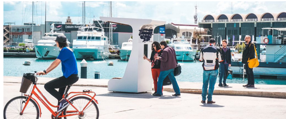
Imagen 21 - Prototipo de banco solar que permite conectarse a Internet por Wifi, cargar por inducción dispositivos electrónicos móviles y acceder mediante una pantalla táctil a apps de interés para turistas y ciudadanos.
