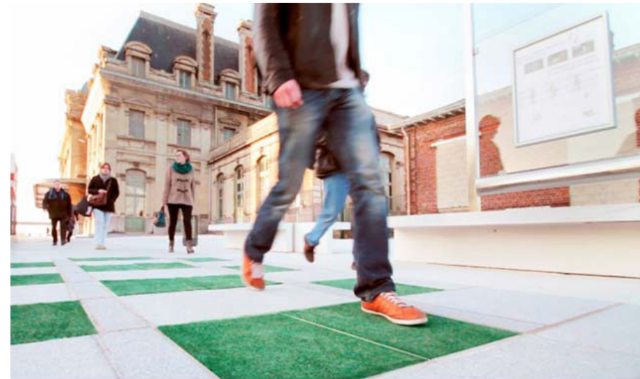
Imagen 14 - Pavegen. Baldosas que generan energía eléctrica con cada pisada de los transeúntes.
