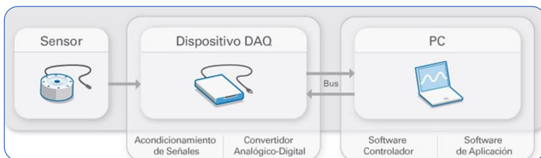
Figura 1. Partes que componen un DAQ. Fuente: NI, 2019.
