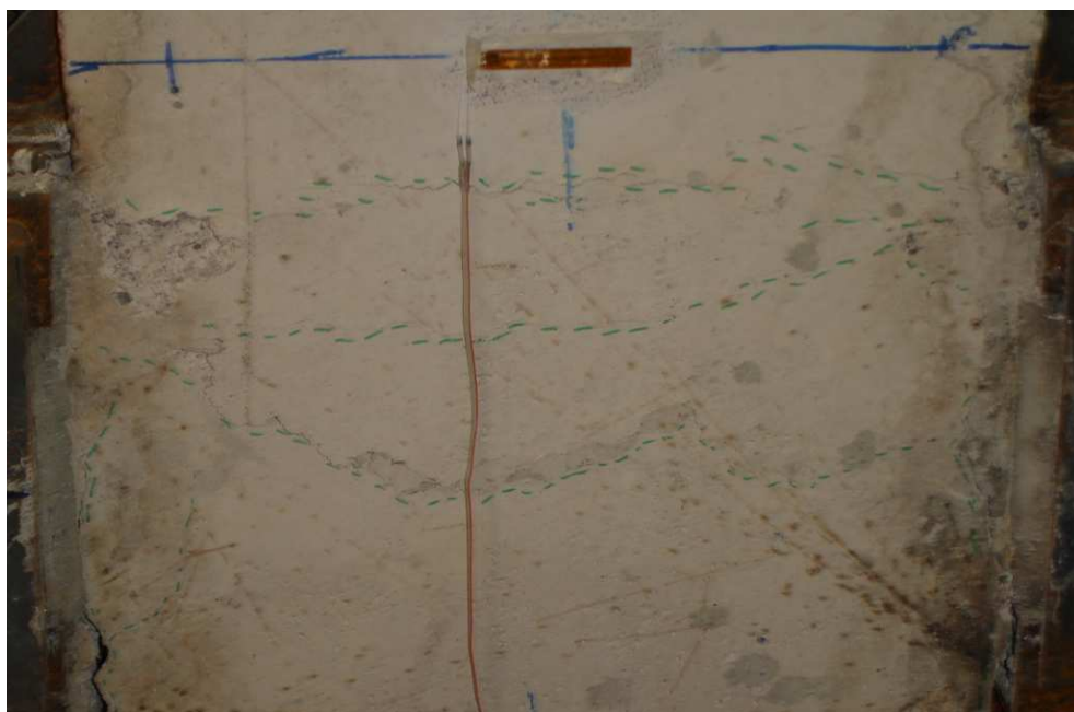
Fig. 3.46. Fisuración y daños aparecidos en la zona de compresión del nudo en las probetas B-L1
