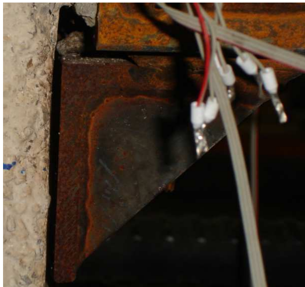
Fig. 3.52. Despegue de los capiteles en la cara de tracción en las probetas B-L2
