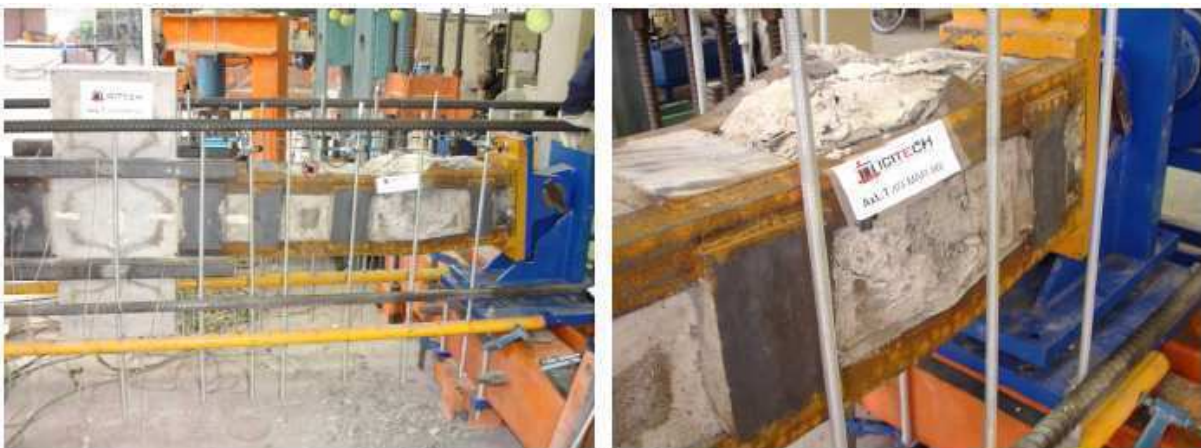
Fig. 2.35. Modo de rotura de la probeta AxL.T (Adam 2007)
