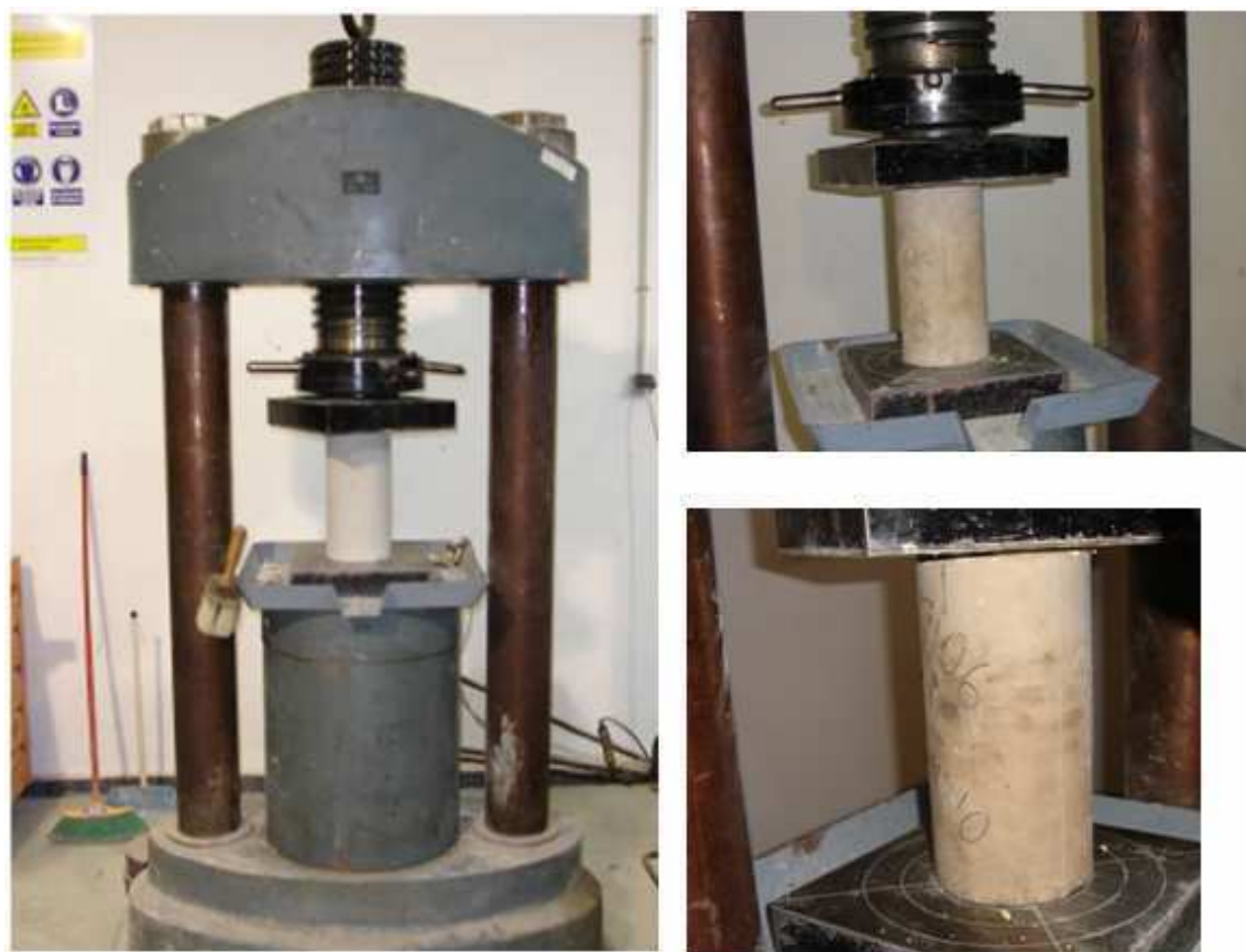
Fig. II.14. Diferentes vistas de la prensa empleada para los ensayos de las probetas cilíndricas
