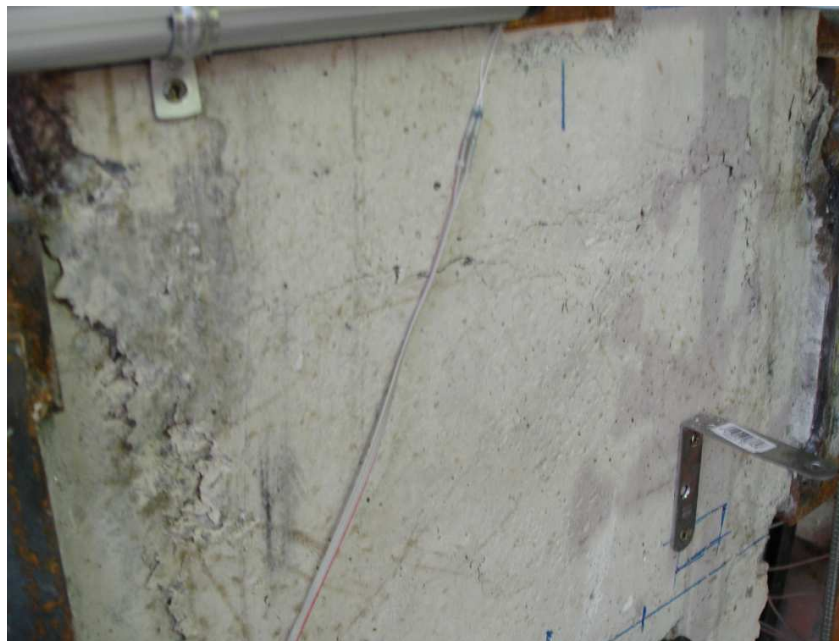
Fig. 3.39. Daño aparecido en la zona comprimida del nudo en las probetas RC-L3
