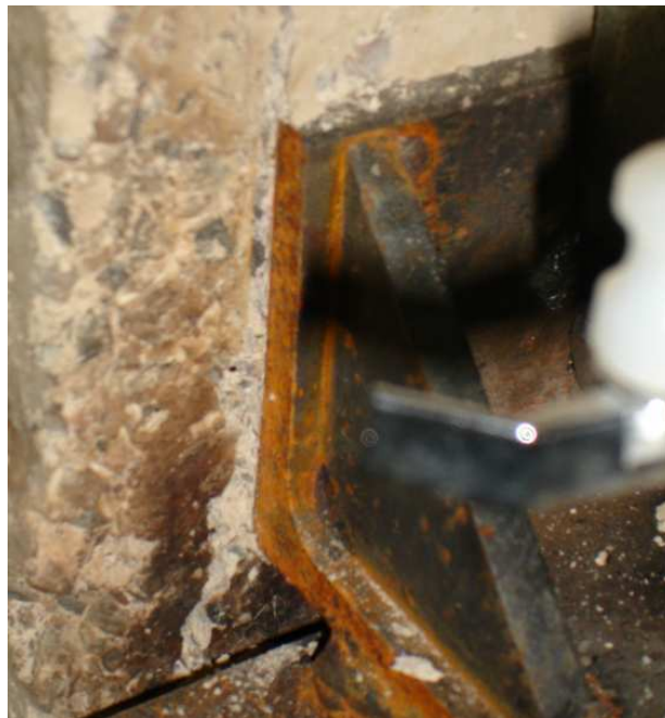
Fig. 3.41. Penetración del capitel en la cara de compresión en las probetas RC-L3
