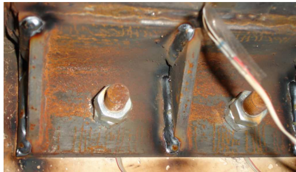
Fig. 3.13. Vista de un capitel con sus rigidizadores y con los elementos de conexión dispuestos (barra pasante en este caso)
