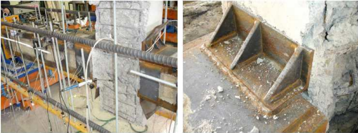
Fig. 2.34. Modo de rotura de la probeta AxL.C (Adam 2007)
