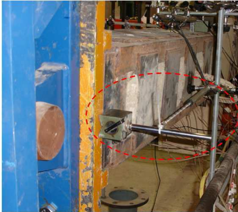
Fig. 3.22. LVDT para medir el acortamiento total de la probeta
