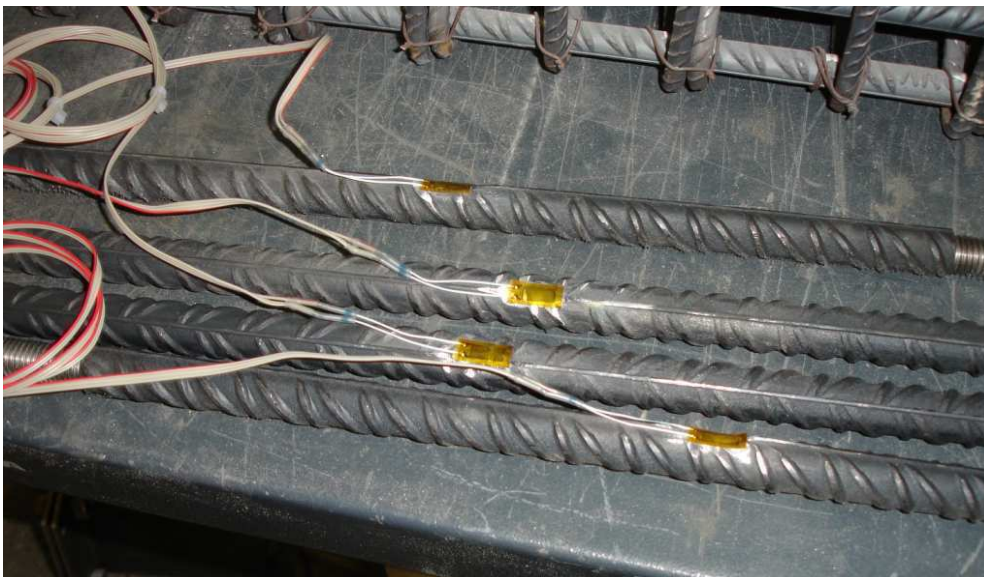
Fig. 3.24. Instrumentación de las barras pasantes mediante galgas extensométricas
