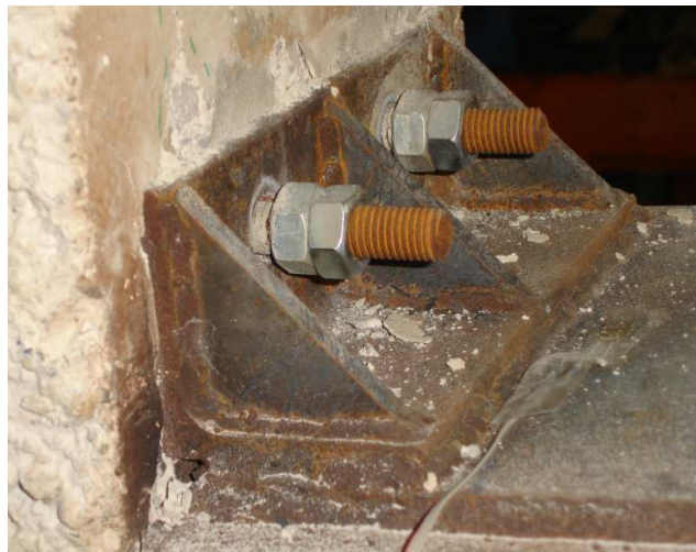
Fig. 3.48. Detalle de la penetración del capitel en el hormigón del nudo, en las probetas B-L1, en donde se aprecia su magnitud por la parte de rosca visible tras las tuercas
