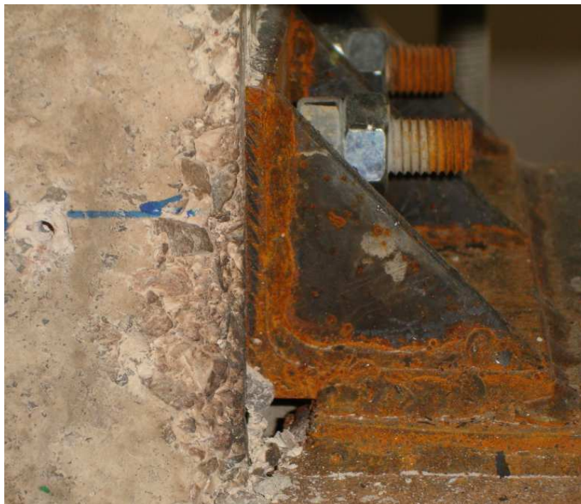
Fig. 3.53. Penetración de los capiteles en compresión en las probetas B-L2
