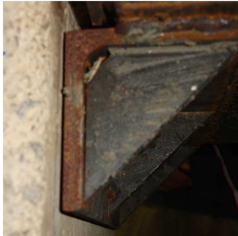
Fig. 3.40. Leve despegue observado en los capiteles de la cara de tracción en las probetas RC-L3
