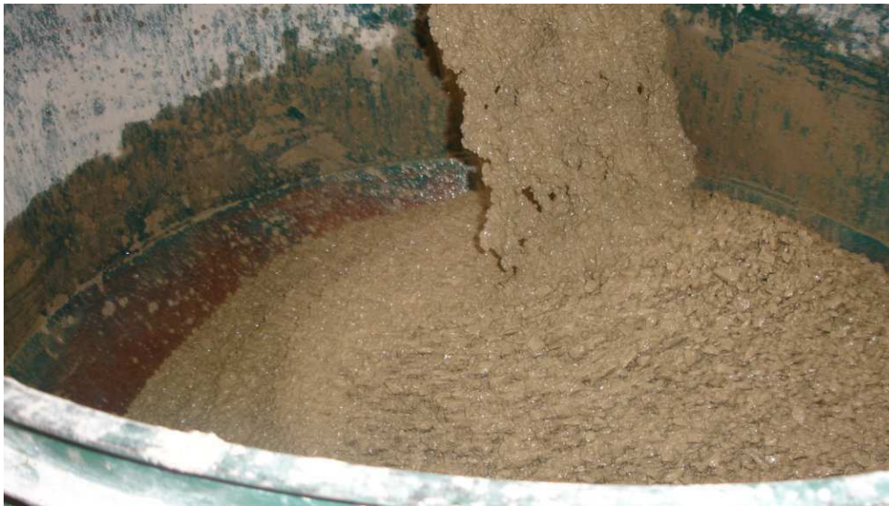
Fig. 3.7. Vista del aspecto del hormigón con el que se fabricaron las probetas ensayadas
