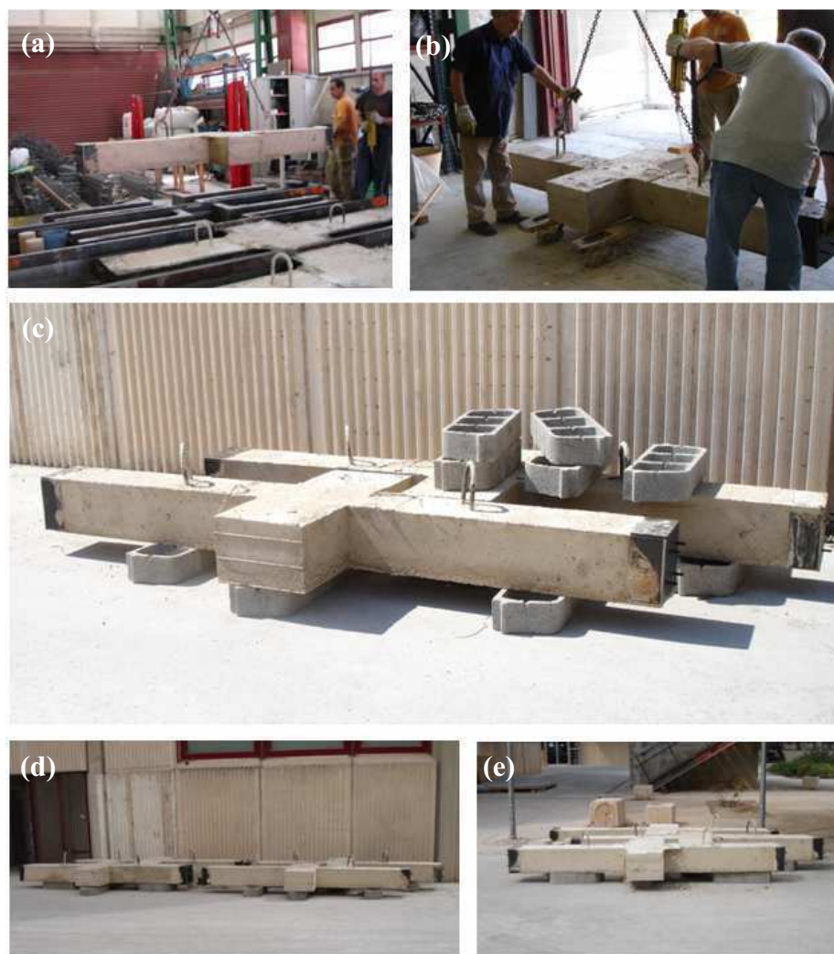
Fig. II.6. Desencofrado de las probetas. (a) Extracción de las probetas de los encofrados; (b) Transporte de las probetas a la zona de acopio; (c) Probetas en la zona de acopio
