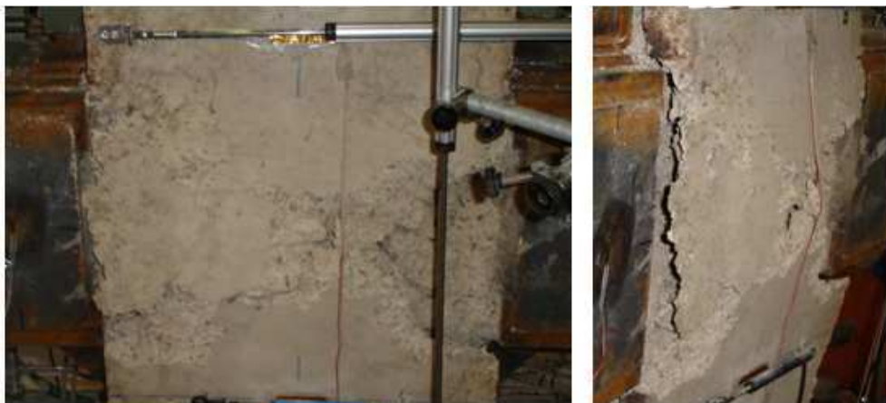
Fig. 3.26. Rotura por pandeo de la probeta B-L3-1
