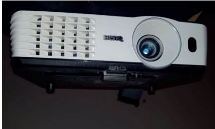
Fig. 37. Proyector Modelo Benc , resolución 1280 x 720px.
