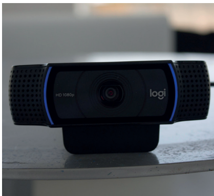
Fig. 38. Modelo Logitech HD Pro Webcam. Posición cenital en la escena colgada en la barra de luces.
