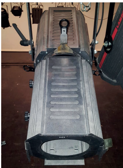
Fig. 39. Foco de luz, recorte. Posición cenital al lado de la cámara cenital, único foco.
