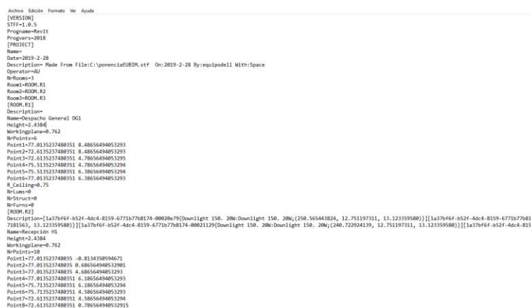
Fig. 5. Ejemplo de archivo de configuración .stf entre REVIT y DIALUX. Fuente: Elaboración propia(2019)
