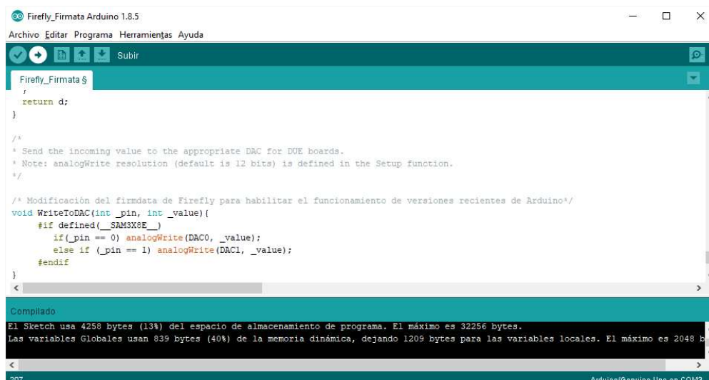
Figura 3. Compilación del firmata modificado de Firefly en la versión 1.8.5 de Arduino. Fuente: Rodríguez Triguero (2018).
