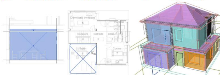
Fig. 4. Espacios (Revit) y Bloques térmicos (ArchiCAD)
