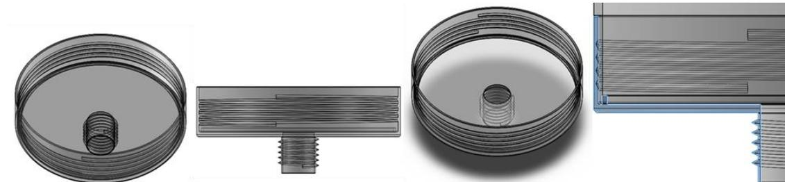
Ilustración 39. 1.3. Tapa inferior depósito.
