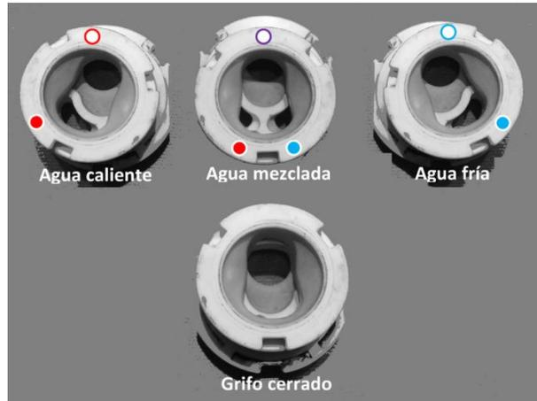
Ilustración 25. Funcionamiento gráfico de cartucho de discos cerámicos.
