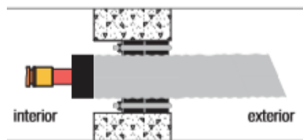
Figura 15. Entrada a usuario con brida estanqueizante FA 80. Fuente: REHAU
