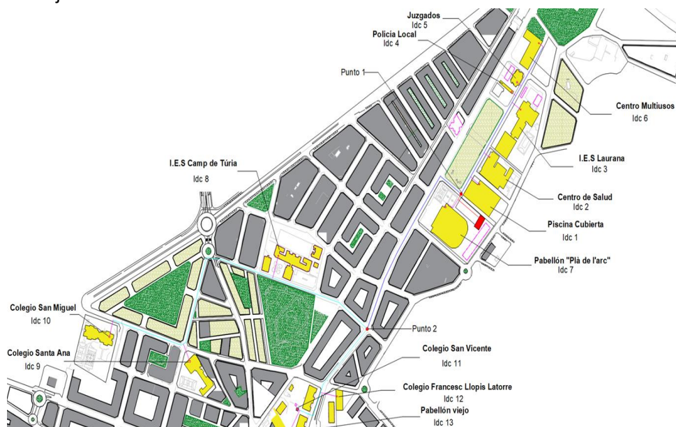
Figura 1. Recorrido de la red de distribución y localización de la central térmica. Fuente: Elaboración propia.
