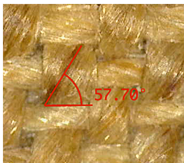
Figura 9. Ángulo de torsión del hilo.
