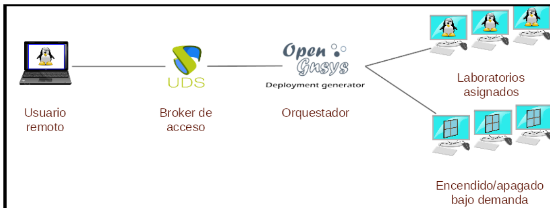
Figura 4.37: Arquitectura del proyecto RemotePC
