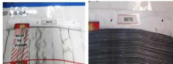
2 - Silueta de la varilla. En la plantilla de cada referencia se representa el contorno de la propia. Se posicionan las piezas haciendo tope en este. Ejerce de poka-yoke impidiendo posicionar una varilla de otra referencia.
