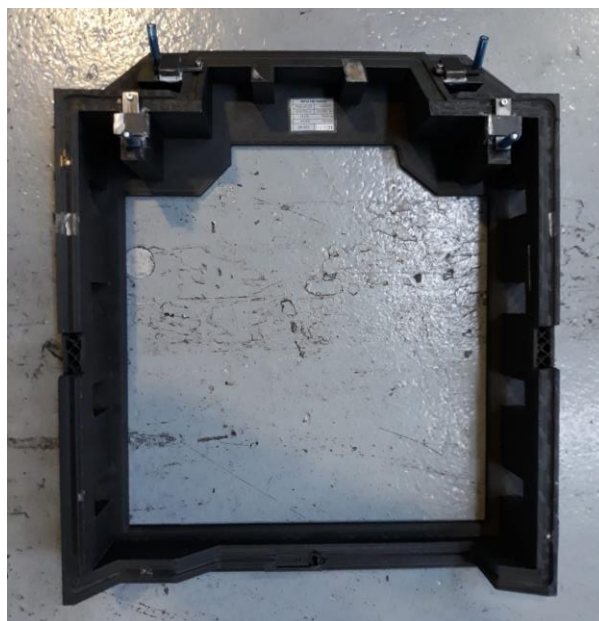
67. Galga de la referencia P51004031 realizada mediante impresión 3D.
