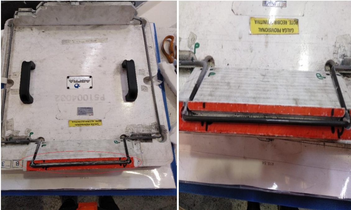
64. Detalle del defecto de la varilla P51004032, NOK sobre la galga.
