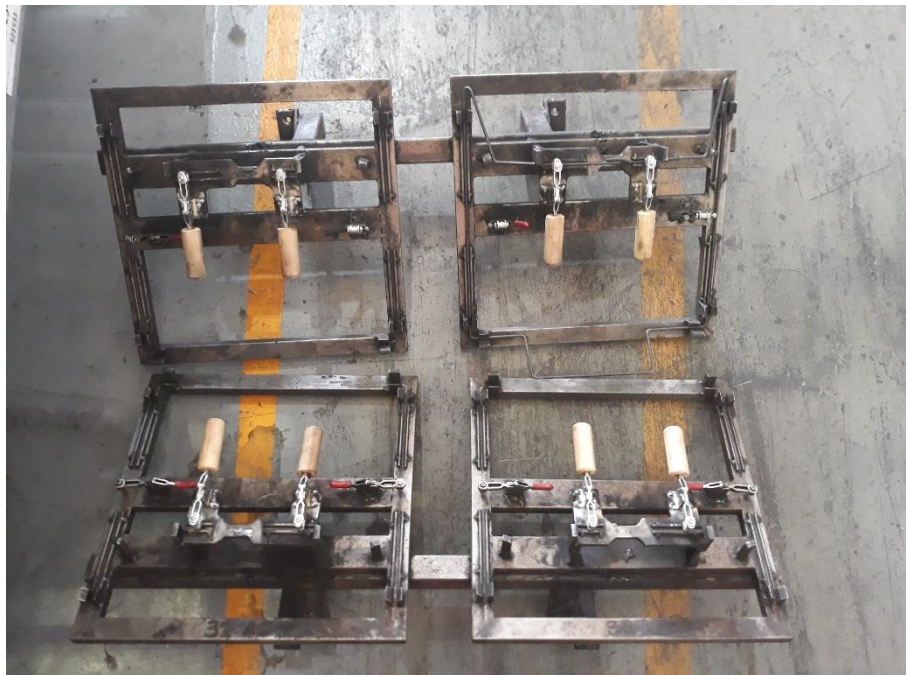
55. Utillaje de soldadura para la referencia P51004031.
