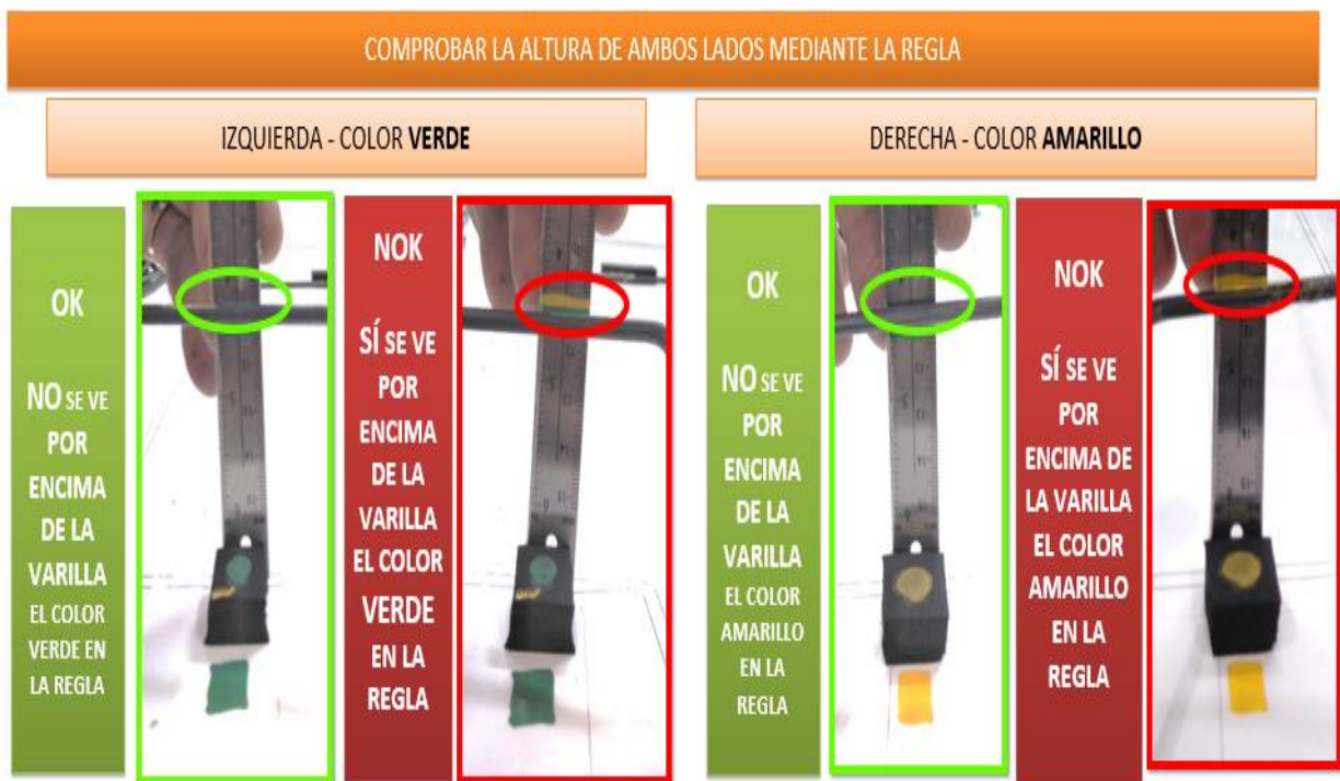
68. Ayuda visual para comprobar la altura de las varillas P51004032.
