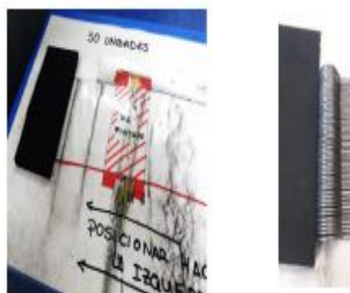
4 - Indica donde posicionar la varilla. Debe estar en contacto con el posicionador negro.
