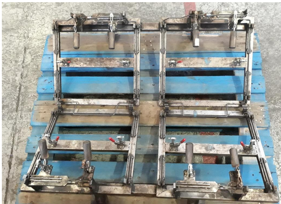
56. Utillaje de soldadura para la referencia P51004032.
