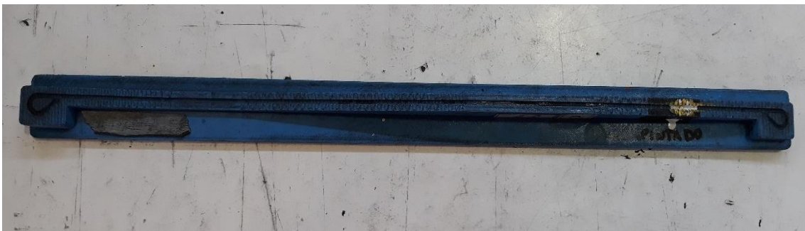
35. Galga para comprobar dimensionalmente la varilla 302733.
