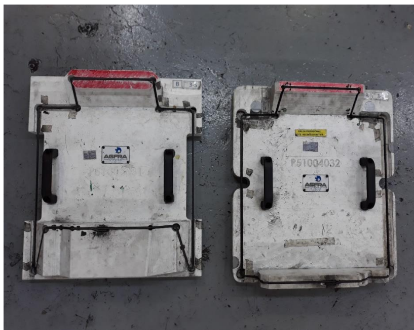
60. Galgas para las varillas con referencias P51004031 (izqda.) y P51004032 (dcha.).
