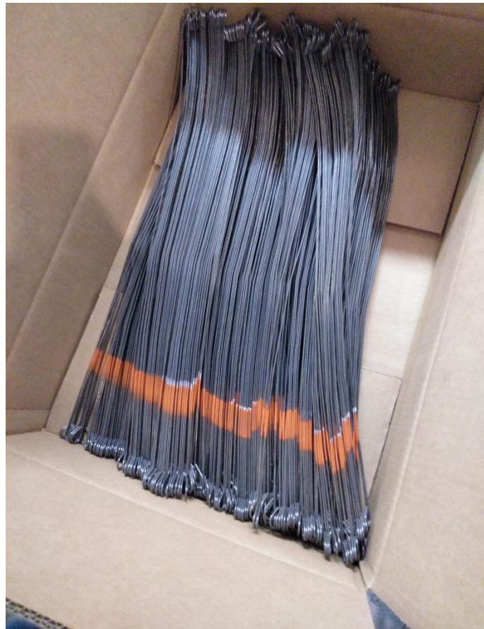
38. Varillas COPO con pintado NOK. Fuente: Elaboración propia
