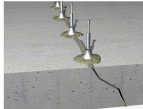
3. Fijación con adhesivo tixotrópico epoxi de inyectores externos.
