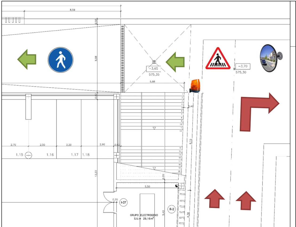
Ilustración 19. Encuentro entre rampa de salida del garaje y rampa accesible desde sótano -1 que sube a planta baja.
