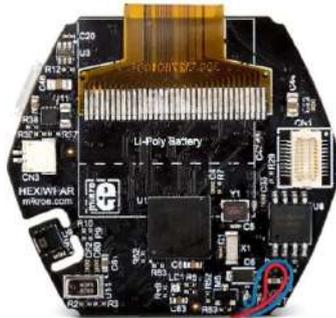
Figura 2.5: Vista frontal interna del dispositivo Mikroe 2026.
