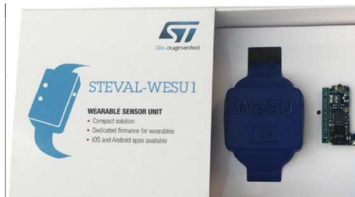
Figura 2.7: Vista frontal tanto interna como externa del dispositivo STEVAL-WESU1.
