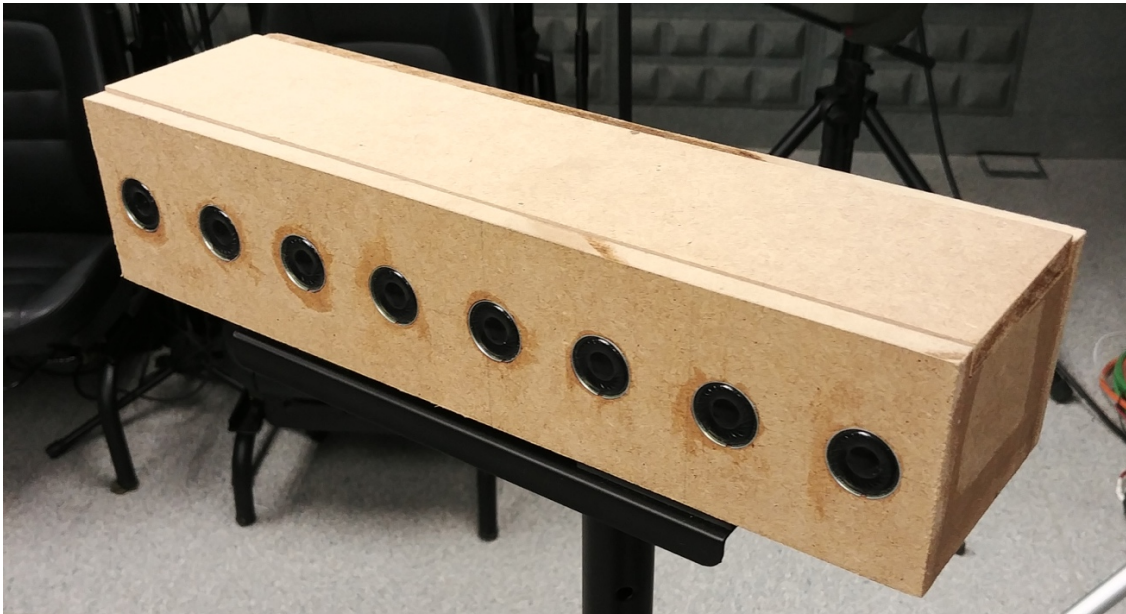
Figura 23. Array terminado con la tapa superior acoplada.
