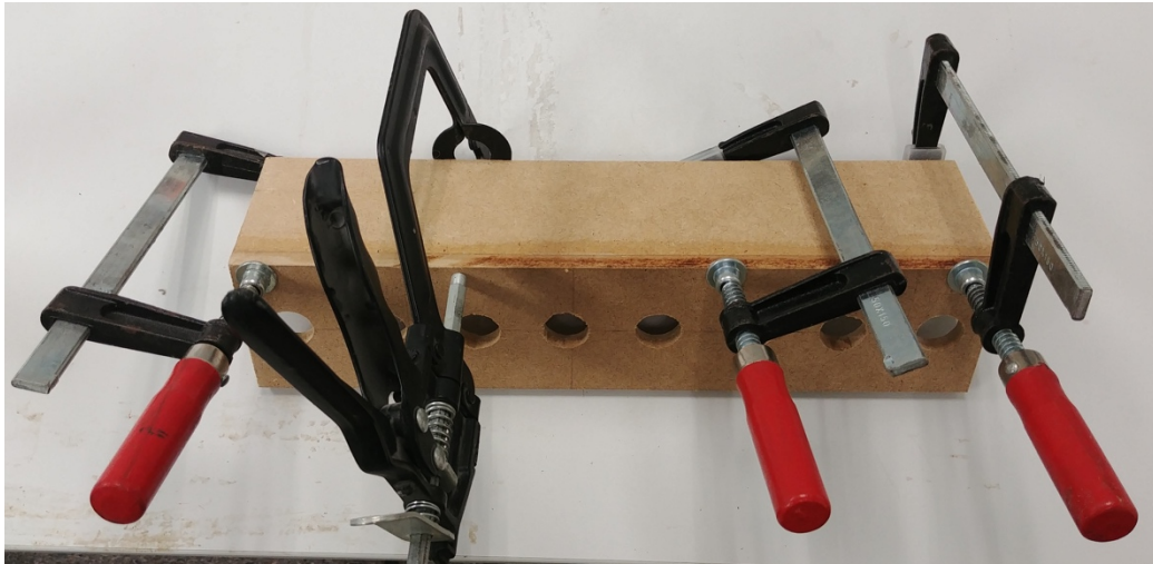
Figura 16. Tapa frontal e inferior pegadas y fijadas con gatos.
