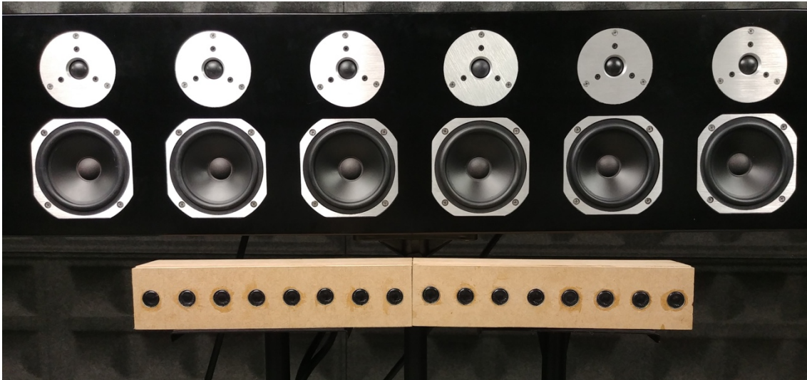
Figura 33. Arrays de altavoces contruidos.
