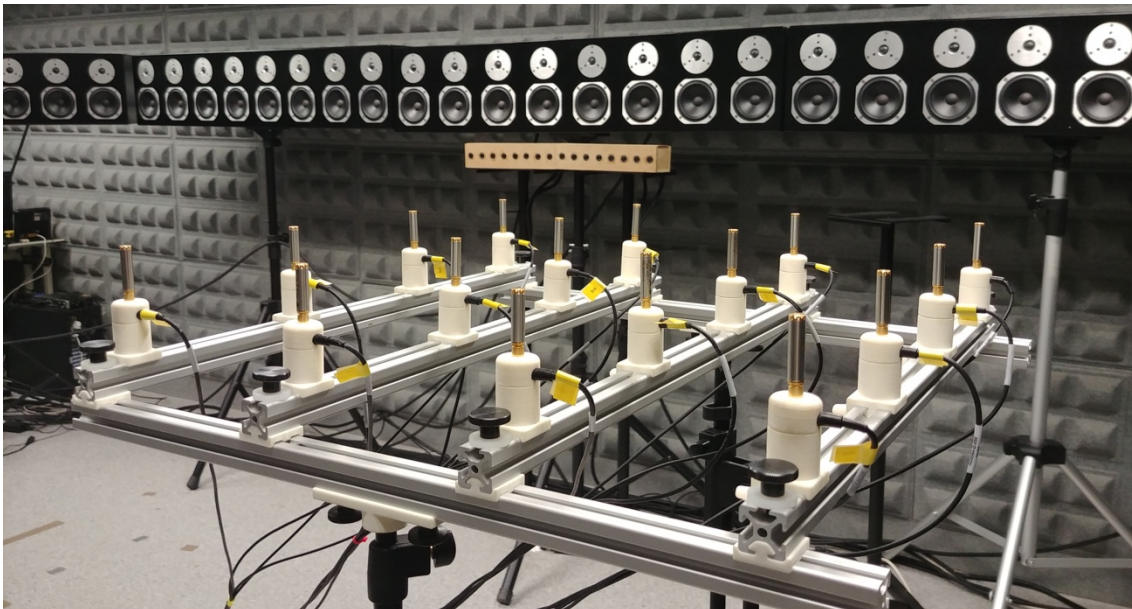
Figura 34. Array de micrófonos situado en una de las zonas.
