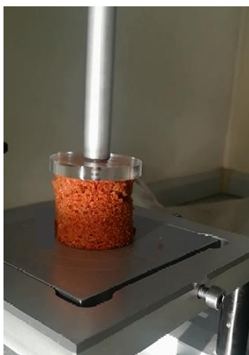
Figura 4. Detalle de la sonda para el ensayo mecánico de doble compresión.
