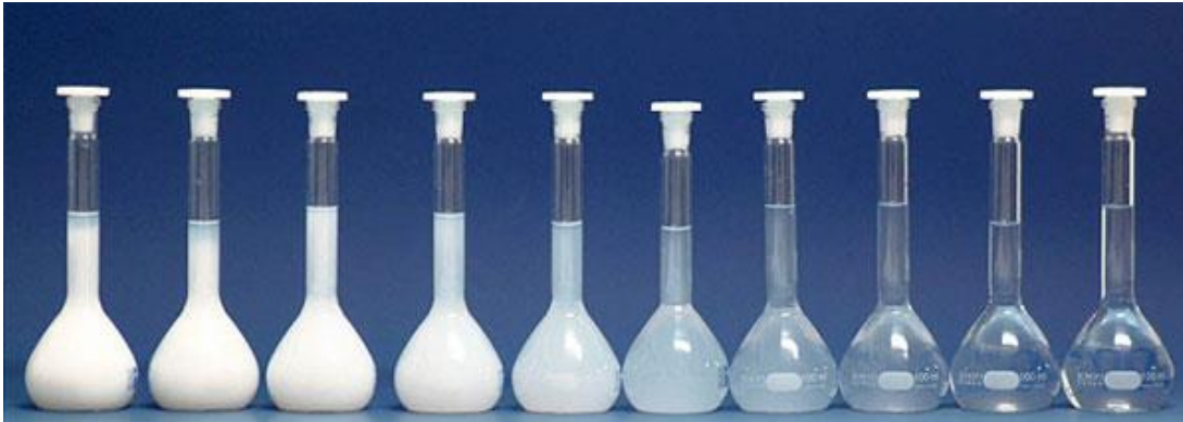
Figura 10. Patrones para la preparación de la escala McFarland desde el más concentrado (izquierda) al menos concentrado (derecha).
